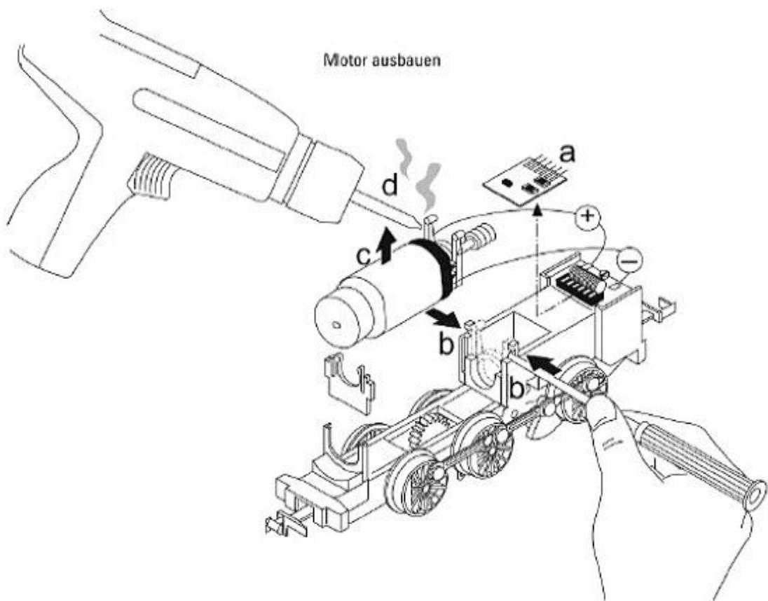
Einbau des Lok-Decoders mit der schwarzen Vergussmasse nach oben. Anschlussdrähte des Decoders nicht kürzer als 5 mm abschneiden!
