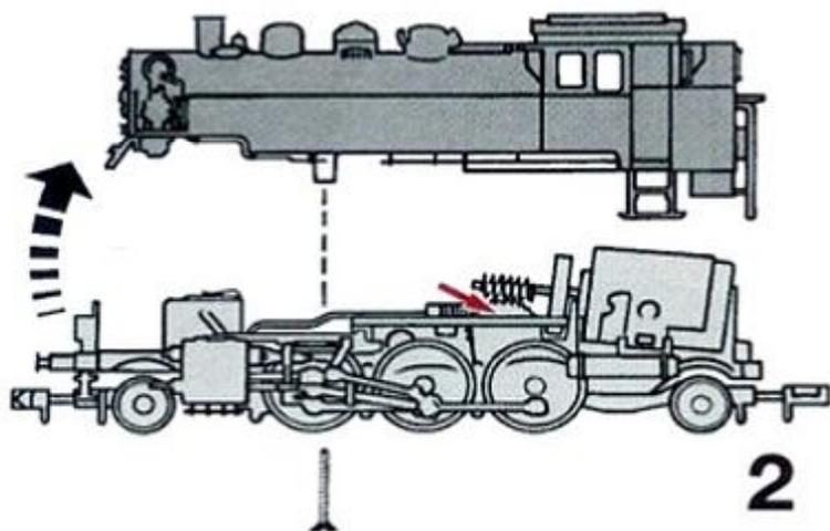
Ein Öffnen der Lok ist nur zum Lampenwechsel und Motorwechsel erforderlich.
