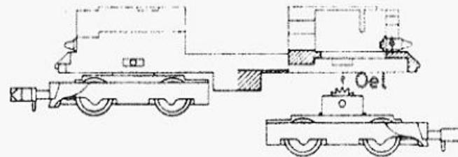
Diese Lokomotive wird mit Gleichstrom bis 12 Volt betrieben. Der robuste Permanent-Magnetmotor mit vollisoliertem, dreiteiligem Anker gewährleistet einen kontinuierlichen Dauerbetrieb und verträgt auch zeitweilige Überlastungen. Der Motor ist bereits funk- und ternsehentstört. Darüber hinaus wird jedoch zur Erzielung einer vollwirksamen Entstörung empfohlen, die Schienenoberkanten von Schmutzablagerungen freizuhalten.
