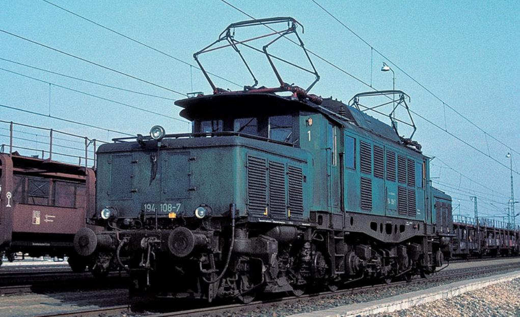
Das Vorbild des ESU-Modells (am 2.3.1983 in Dingolfing) zeigt alle typischen Merkmale der Zeit: Stromabnehmer des Typs SBS 39 mit unterschiedlicher Isolation, Dachverlängerung als Berührungsschutz bei abgesenkten Stromabnehmern, 3. Spitzenlicht am Vorbau, UIC-Steckdose. Die gelben Ecken an den Revisionsklappen dienten dem Unfallschutz. Foto: Christian Völk
