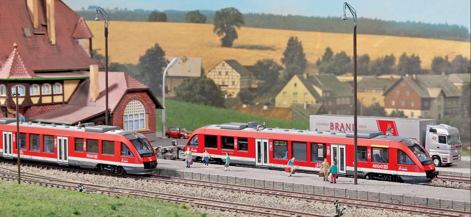
Seit Herbst 2000 steht der einteilige Dieseltriebwagen LINT 27 nicht nur bei der DB AG im täglichen Einsatz, sondern auch bei vielen anderen regionalen Verkehrsträgern. Je nach Fahrgastaufkommen sind die Triebfahrzeuge solo oder mit mehreren Fahrzeugen in Mehrfachtraktion unterwegs. Mit einer Höchstgeschwindigkeit von 120 km/h ist er gleichermaßen auf Neben- wie auch auf Hauptbahnen einsetzbar, was ihn für den Modellbahnbetrieb besonders interessant macht.
