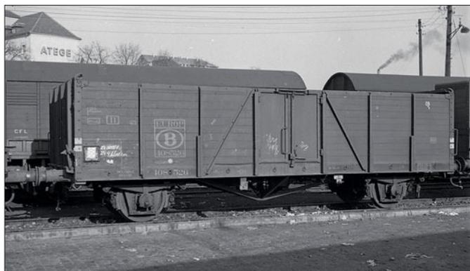
Bis auf die Puffer und den An-Aus-Hebel der Bremse noch im Originalzustand: der EUROP-Wagen 408 526 der SNCB. Foto: Fritz Willke
