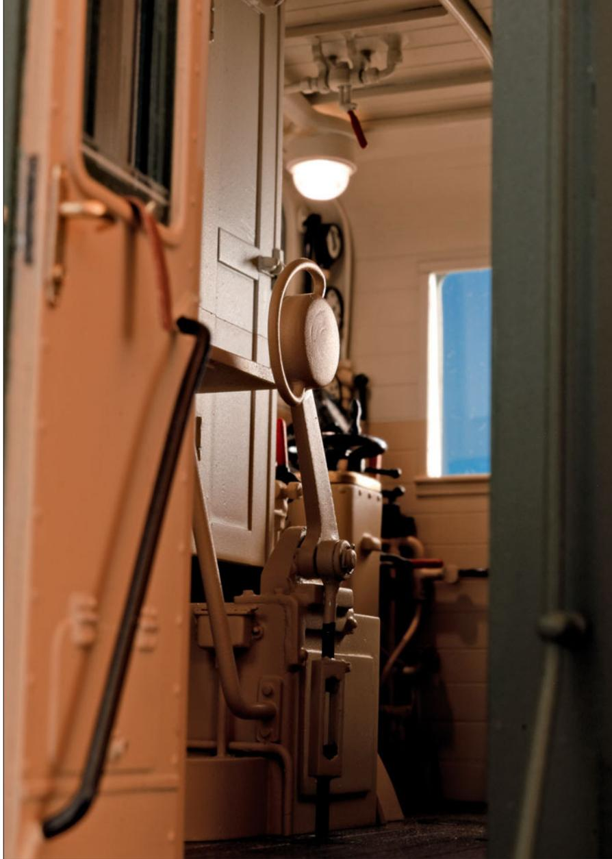
Noch ein Blick in den Führerstand. Im Vordergrund ist die Wurfhebelbremse sichtbar, dahinter thront das Fahrstufenwählrad auf seiner Messingkonsole.
