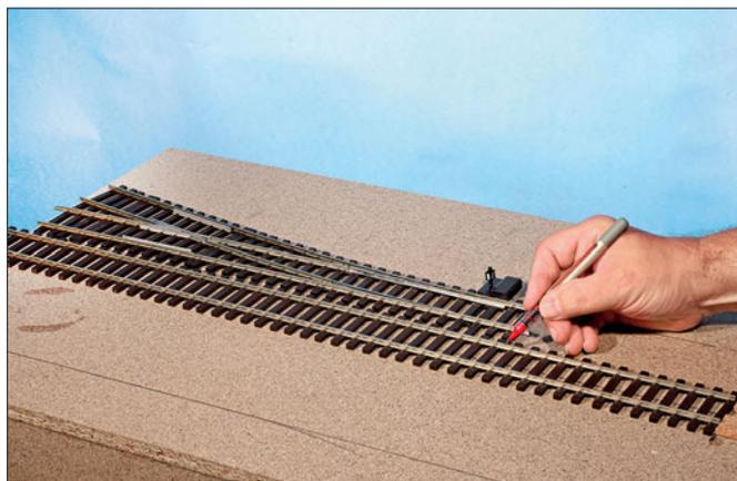
Vom Flexgleisstück wird die Länge des noch an die Weiche anzusetzenden Gleisstückes ermittelt und zum Abtrennen deutlich markiert.
