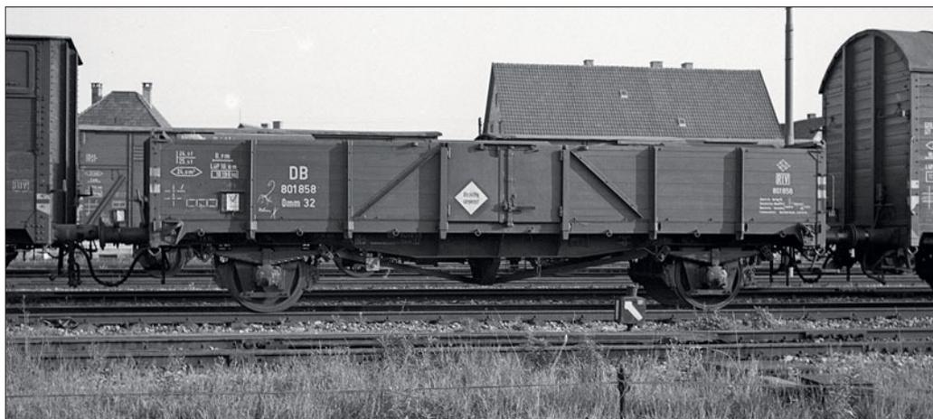
verkehr für 29,0 t Tragfähigkeit ausgelegt (im Regelverkehr für 25,5 t). Anders als die Ommr Linz erhielten sie Untergestelle mit Außenlangträgern, die ebenfalls mit räumlichen Sprengwerken unterstützt waren.
