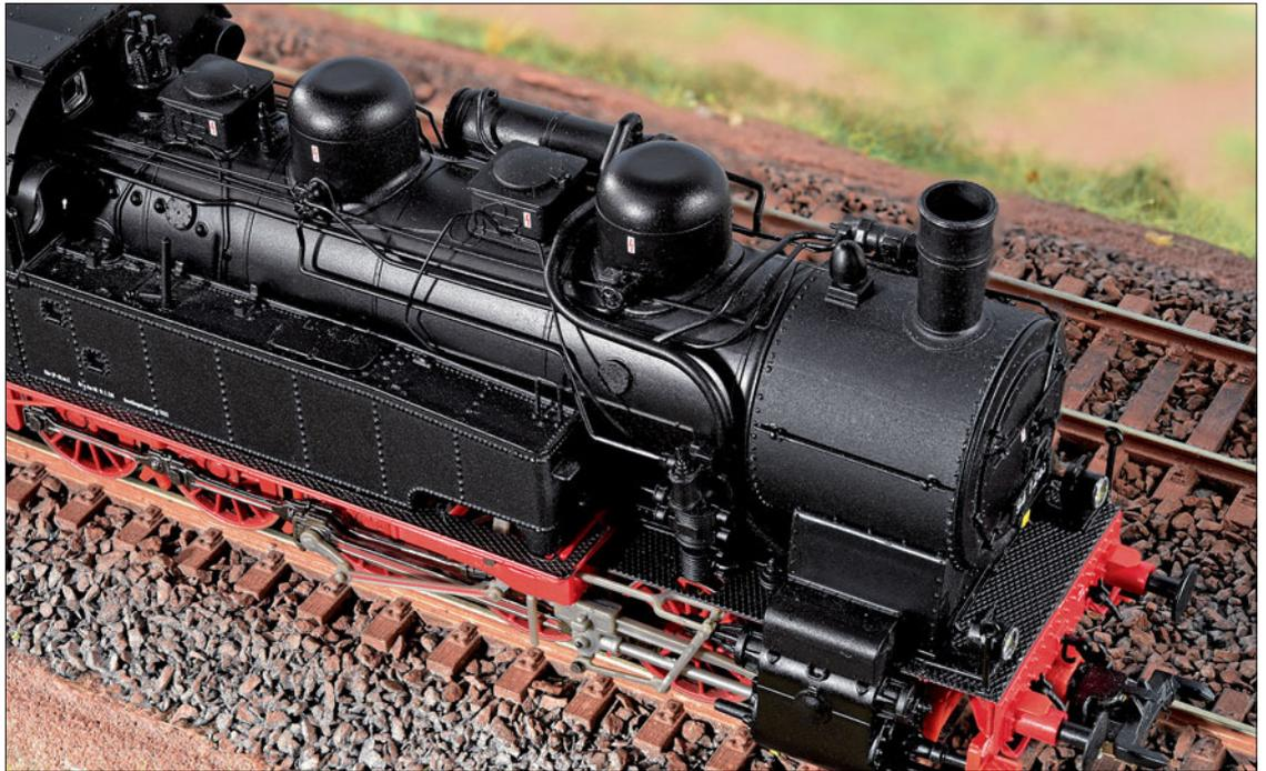
Bei der Lackierung bietet ESU eine Neuerung, die erst auf den zweiten Blick auffällt. Während Kessel, Wasserkästen und Führerhaus in gleichmäßigem Seidenglanz schimmern, ist die Rauchkammer mattschwarz lackiert! Das entspricht durchaus dem Erscheinungsbild einer im Betrieb stehenden, gleichwohl gepflegten Maschine.
