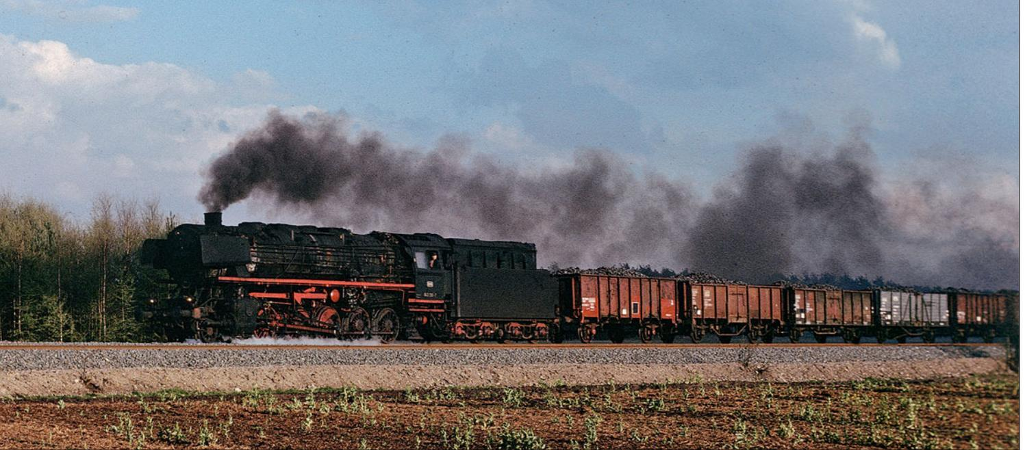
Am Abend des 27. April 1977 rumpelte 043 100 mit dem Gag 75773 – einem Koks zug von Rheine nach Emden – durch die langgestreckte Kurve nördlich von Bernte. Der dritte Wagen war ein aus einem Omm 33 umgebauter E 033 der DB, der vierte ein mit einem Außensprengwerk verstärkter ehemaliger Omm Villach der CFL, vermutlich zu dem Zeitpunkt einer der letzten seiner Bauart. Foto: SC
