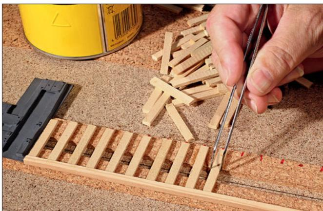
Die Bildfolge unten zeigt das Vorgehen: Zuerst werden die Platten auf den Schwellen an der markierten Schienenlage aufgeklebt. Nach dem Einschlagen der Nägel wird innen die Klemmplatte aufgelegt und die Schrauben werden ins Holz gedrückt. Zuletzt wird der Nagel bis zum Schienenfuß eingedrückt.
