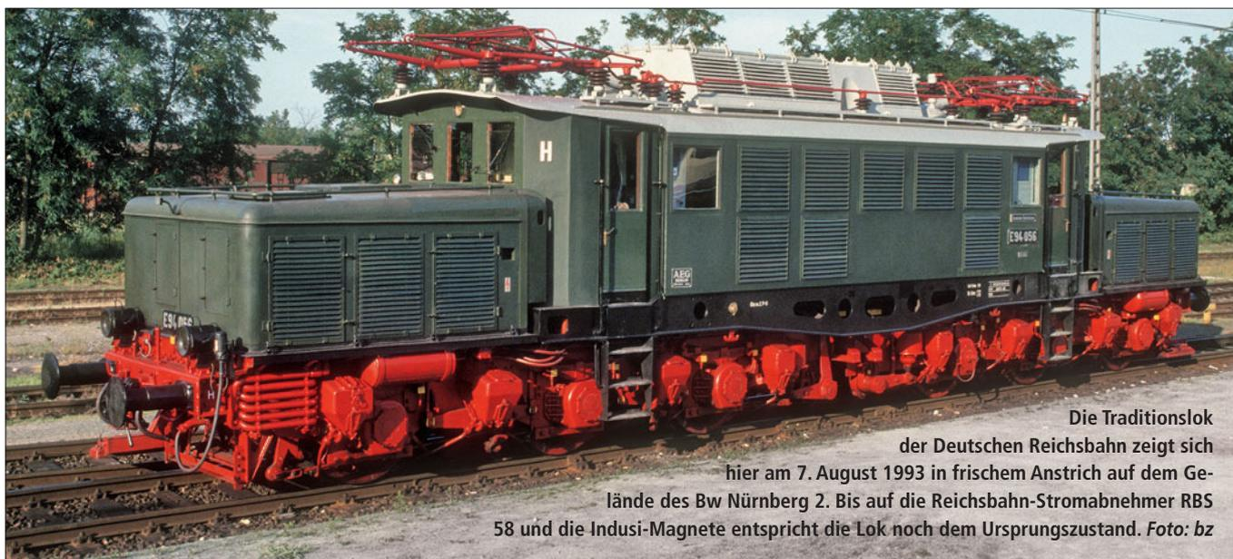
Die Traditionslok der Deutschen Reichsbahn zeigt sich hier am 7. August 1993 in frischem Anstrich auf dem Gelände des Bw Nürnberg 2. Bis auf die Reichsbahn-Stromabnehmer RBS 58 und die Indusi-Magnete entspricht die Lok noch dem Ursprungszustand. Foto: bz
