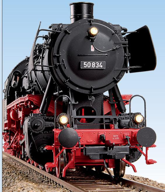
Das „Gesicht“ der 50er ist ebenso gut getroffen wie Details an Pufferbohle, Zylindern und Umlaufstützen.
