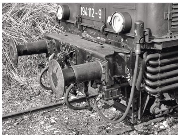
194 112 war eine der zehn Loks, die für den Einbau der automatischen Mittelpufferkupplung vorbereitet wurden und dazu einen separat angesetzten Verschleißpufferträger erhielten. Da deshalb die ursprünglichen Konsolen für die Signallaternen entfielen, erhielten die Loks Einheitslaternen des Typs SL1 mit einem aufgesetzten Gehäuse.
