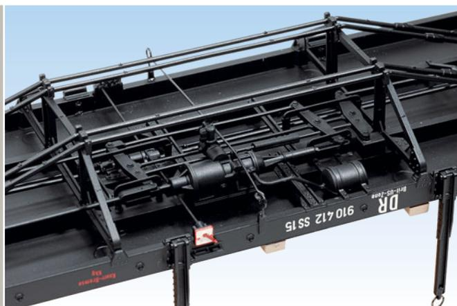
Das Sprengwerk aus Stützen und Zugstangen (-rohre) sowie die feingestaltete Bremsanlage sind echte Hingucker.
