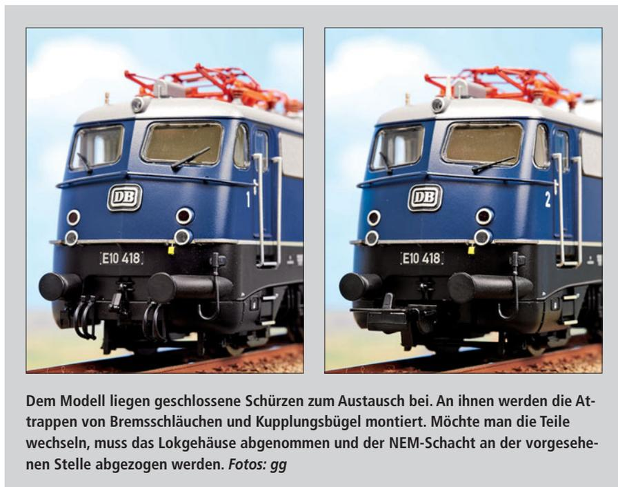
Dem Modell liegen geschlossene Schürzen zum Austausch bei. An ihnen werden die At-trappen von Bremsschläuchen und Kupplungsbügel montiert. Möchte man die Teile wechseln, muss das Lokgehäuse abgenommen und der NEM-Schacht an der vorgesehe-nen Stelle abgezogen werden. Fotos: gg
