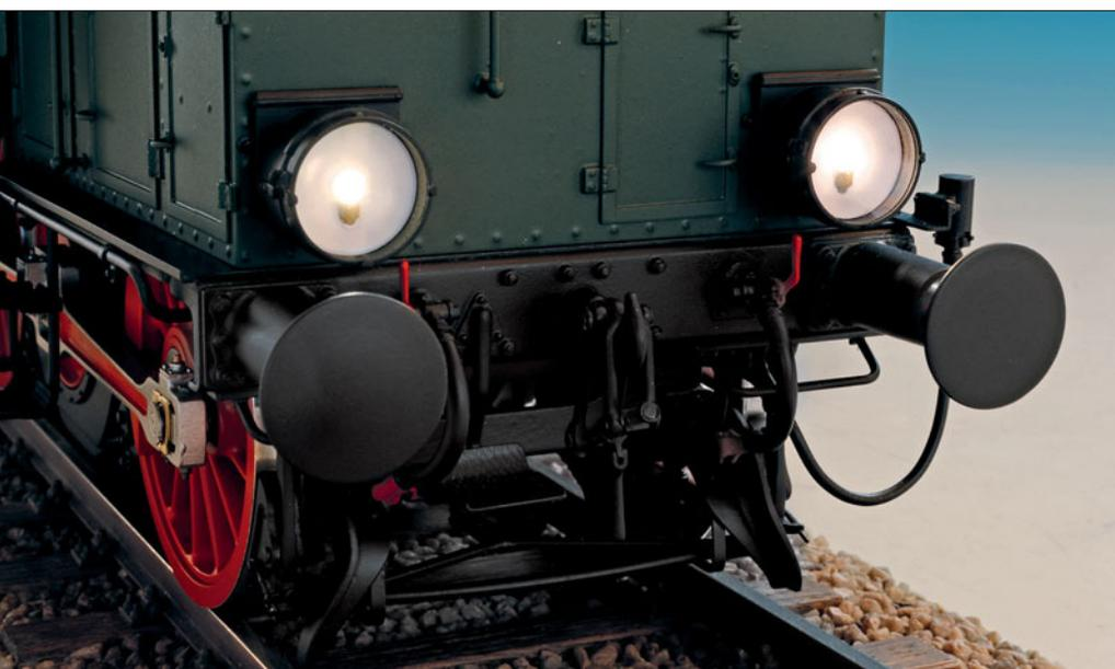
Die Stirnbeleuchtung hat Reiner Schartmann so ausgeführt, dass das Licht wirklich dort emittiert wird, wo die Imitate der Glühlampen sitzen. Dadurch wirkt das beleuchtete Modell ungeheuer natürlich.
