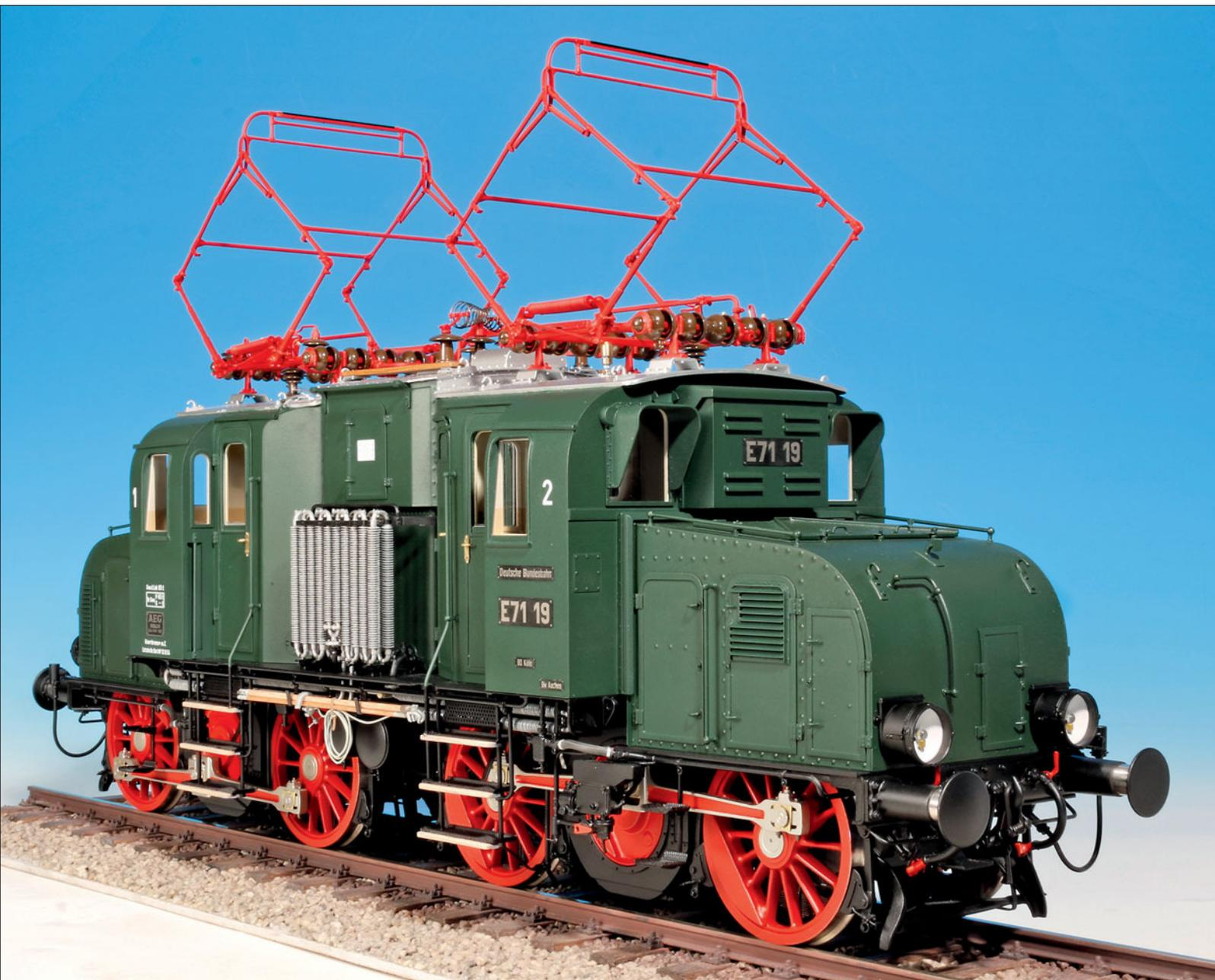
Die Nietenköpfe auf den Motorkästen und im Dachbereich wurden vor dem Zusammensetzen der Einzelteile mit Hilfe einer Tischbohrmaschine geprägt. Das lässt sich gerade bei dünnen Blechen mit Stempel und Matrize sehr sauber ausführen.
