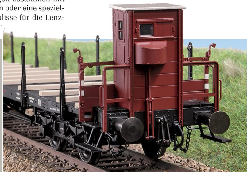
Bremsbühne mit -haus, Rangiergriffe, Signalscheibenhalter, Bremspindel, Zurrösen u.v.m. laden zum Betrachten ein.
