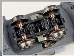
Die angetriebenen Achsen sind zugunsten eines langlebigen Betriebs in Messingbuchsen gelagert.
