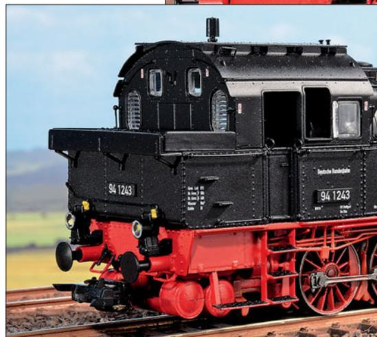
Der Kohlenkasten der 94 1243 kommt vorbildgerecht ohne die Erhöhung aus. Bemerkenswert: Die separat angesetzte E-Leitung mit den gelb abgesetzten Anschlussdosen für die Laternen. Unten: Filigrane Kunststoffteile in hellem Grau sind bei der Steuerung mit recht dunklen Stangen aus Metall kombiniert.
