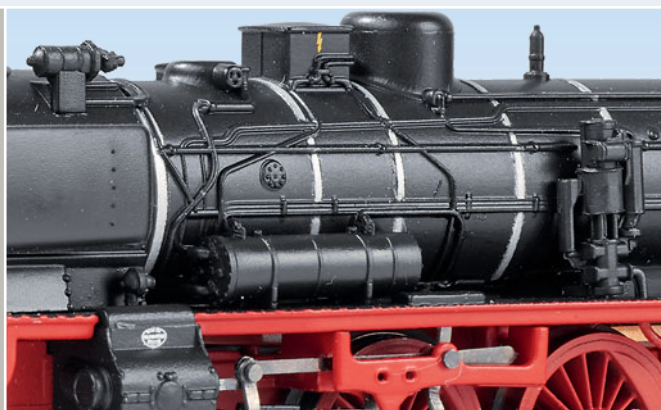
Heizerseite der 78.10 mit angesetzter Speisewasserpumpe, Vorwärmer und Generator
