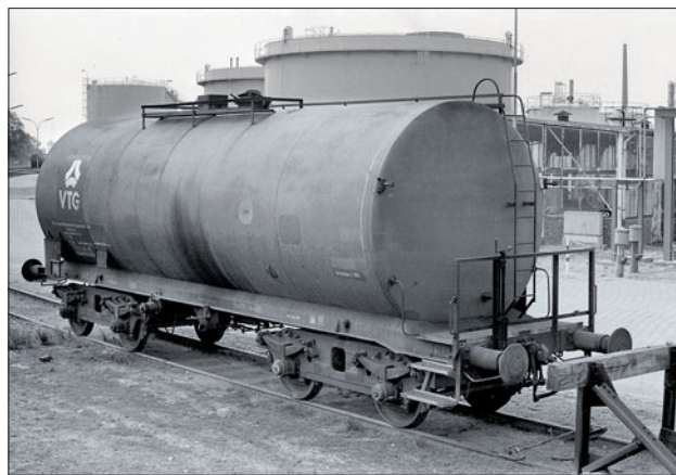
VTG-Kesselwagen im Wandel der Zeit. Links der 075 0 144 [P], aufgenommen im Dezember 1970: die Drehgestelle waren verstärkt und mit Rollenlagern ausgerüstet, aber immer noch mit Ketten gegen Durchdrehen gesichert. Rechts der 770 0 250 [P] Ende der 80er-Jahre im Hamburger Hafen auf der Hohen Schaar: Inzwischen sind die Gefahrguttafeln dazugekommen, die Holztritte durch Gitterroste ersetzt und die Ketten an den Drehgestellen entfallen. Fotos: Joachim Claus, Benno Wiesmüller
