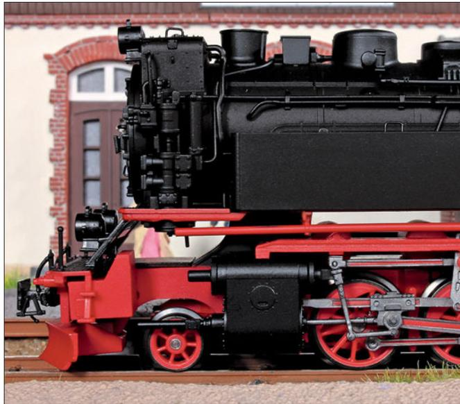
Im Detail ist die Mischvorwärmer-Speisepumpe und der Mischvorwärmer zu erkennen. Ihre Nachbildung entspricht mit der Leitungsführung dem Vorbild. Das gilt auch für die Zylinder mit ihren Hauptabmessungen. Größe und Form von Schornstein und Speisedom sind korrekt. Über dem ersten Kuppelradstand befindet sich der Hauptluftbehälter
