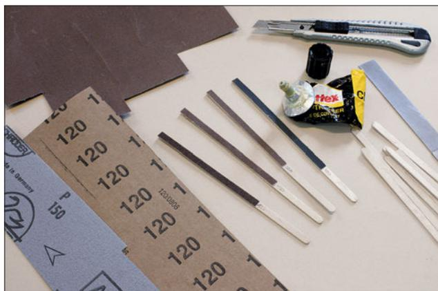
Beim Gebäudeselbst- oder -umbau benötigt man für die diversen Fenster- oder Türöffnungen immer wieder schmale Feilen, um die Ecken akkurat nachzuarbeiten. Mit Schleifpapier in verschiedenen Stärken, die auf hölzerne Umrührstäbchen geklebt werden, lassen sich diese Werkzeuge leicht selbst anfertigen.
