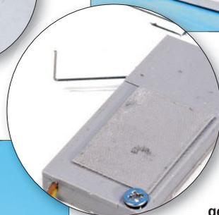
Zum Drehen des Wasserkrans wird ein 0,5 mm dicker, nach oben gekrümmter Stahldraht verwendet, der im Stellrad des Viessmann-Antriebs eingesteckt ist.
