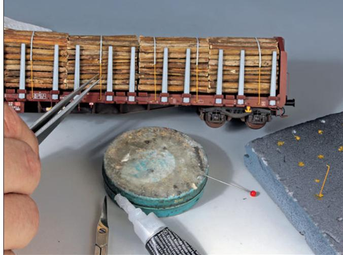
Die Spannbänder zur Ladungssicherung werden in 1:87 mit Abschnitten des Weinert-Abklebebandes 9341 und L-förmig gebogenen 0,2-mm-Ms-Drähten nachgebildet. Nach dem Lackieren der Spannbänder in Lichtgrau (Revell 371) und dem Kürzen auf 19,5 mm, gemessen von den Befestigungsösen, kann man die zuvor gelb (Revell 310) lackierten Haken aus Messingdraht unter den Bändern mit Sekundenkleber befestigen.
