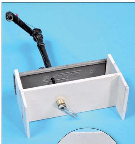
Der Stellhebel ist mit einem langen Schlitz für die Aufnahme des Antriebsstelldrahtes ausgestattet.
