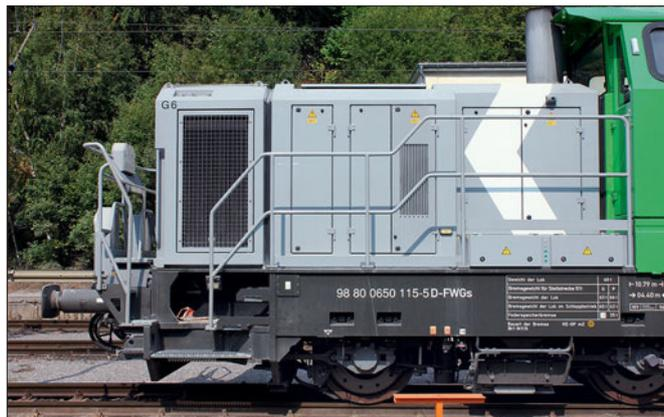
Der längere Vorbau beherbergt den Motor und die Kühlanlage. Der seitliche Aufstieg bietet viel Platz für den Rangierer oder Lokrangierführer. Die Führerhäuser können nur von den Stirnseiten über die Umläufe betreten werden. Über der Pufferbohle ist ein breiter Stand.
