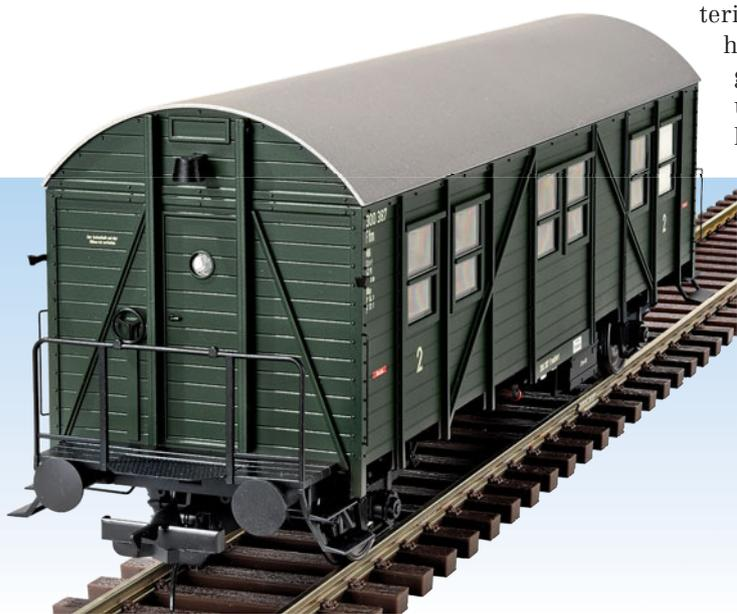
Stirnsicht des MCI 43 mit Handrad für die Bremse und Schluss-scheibenhaltern. Fotos: gp
