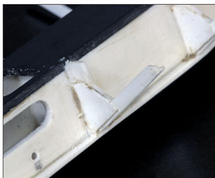
Links oben sind die 0,5 mm starken inneren Versteifungsbleche aus Polystyrol mit den Aussparungen für das Hauptbremsgestänge zu erkennen, oben der neue vorbildgerechte Mittellängsträger mit seinen flacher geneigten Enden im Vergleich zum Märklin-Original.
