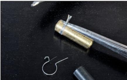
Die Haltebänder des Luftbehälters werden über einem 2,8-mm-Spiralbohrer vorgebogen, mit einer Klemmpinzette fixiert und verlötet. Die zusammengebogenen Enden dienen später als Befestigungszapfen im Beschwerungsblech.
