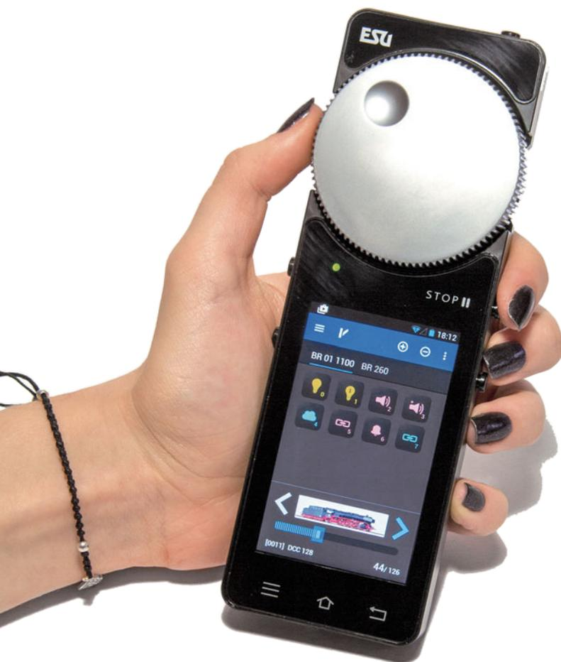
Deborah Schneider demonstriert die Gestaltung des Mobile Control II: gleichermaßen geeignet für Rechts- wie für Linkshänder und auch für kleinere Hände. Smartphoneerfahrene Anwender können mit dem Daumen sowohl die Menü-Schaltfläche (links oben auf dem Bildschirm) als auch die Schaltfläche für den Funktionswechsel „Fahren/Schalten“ (rechts daneben) erreichen. Die frei konfigurierbaren Taster lassen sich mit Zeige- und Mittelfinger bequem erreichen, auf der anderen Seite muss der Daumen „ran“.
