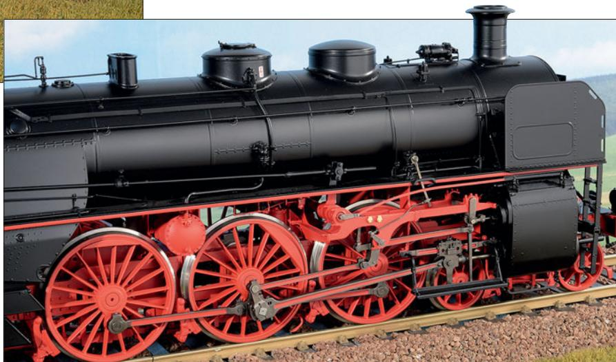
Die rechte Seite des Lokkessels zeigt sich vorbildgerecht glatt und vermittelt die Eleganz der Maschine in besonderer Weise. Die Steuerung der Lok wird über einen Servo je nach Fahrtrichtung korrekt eingestellt.
