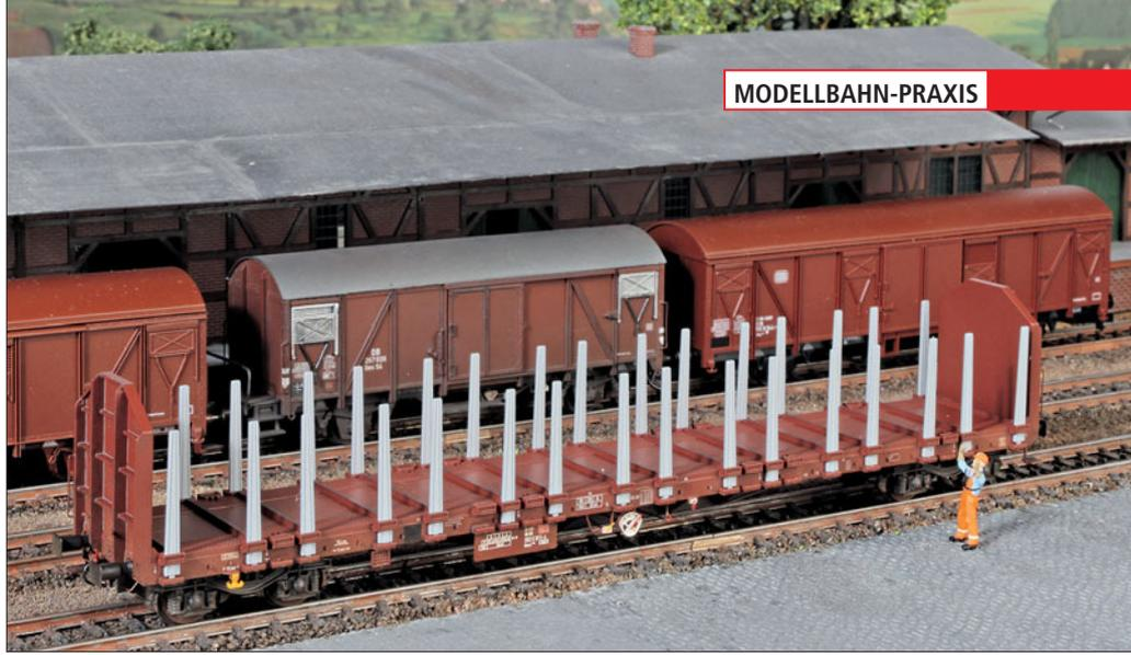
Das soll beim Umbau herauskommen: ein dem Vorbild entsprechendes Modell. Die Draufsicht des unbeladenen Wagens zeigt den geänderten Wagenboden, bei dem alle für die Standardverteilung nicht benötigten Ladeschwellen zwischen den Rungentaschen entfernt wurden.
