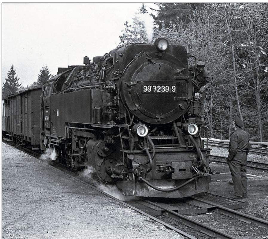
**14** Seit über 60 Jahren locken die Loks der Baureihe 99<sup>23-24</sup> zum Brocken und prägen das Bild der Harzer Schmalspurbahnen. Sebastian Koch stellt nicht nur diese erfolgreiche Meterspurlok vor, sondern unterzog auch das aktuelle Modell der 99 247 von Tillig in der Baugröße H0m einem ausführlichen Test. *Foto: Frank Pilz*
