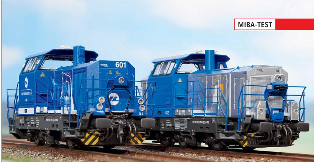
Die Unterschiede sind auch in der Frontgestaltung augenfällig: Einen Kühlergrill gibt es nur bei der VPS-Maschine, deren Original einen Cummins-Motor besitzt. Fotos: gg
