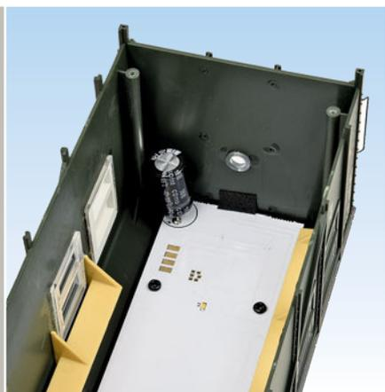
Die Digitalelektronik mit Energiespeicher und LEDs ist im Dach untergebracht.
