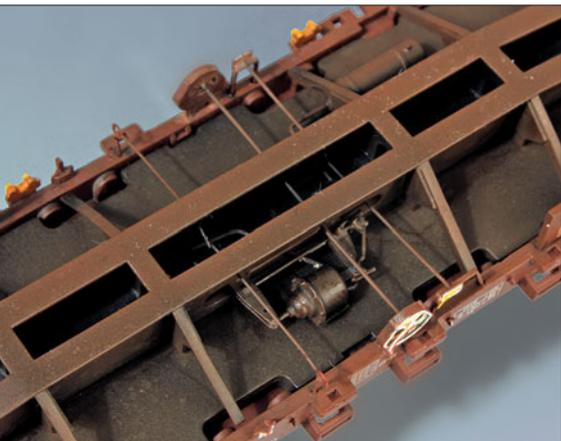
Die eingebaute KE-GP-Bremsanlage samt Brems- und Zugumsteller sowie Lösezug, von der Bremszylinderseite aus gesehen (oben) sowie von der Seite des selbstgebauten Bremsluftzylinders (unten)
