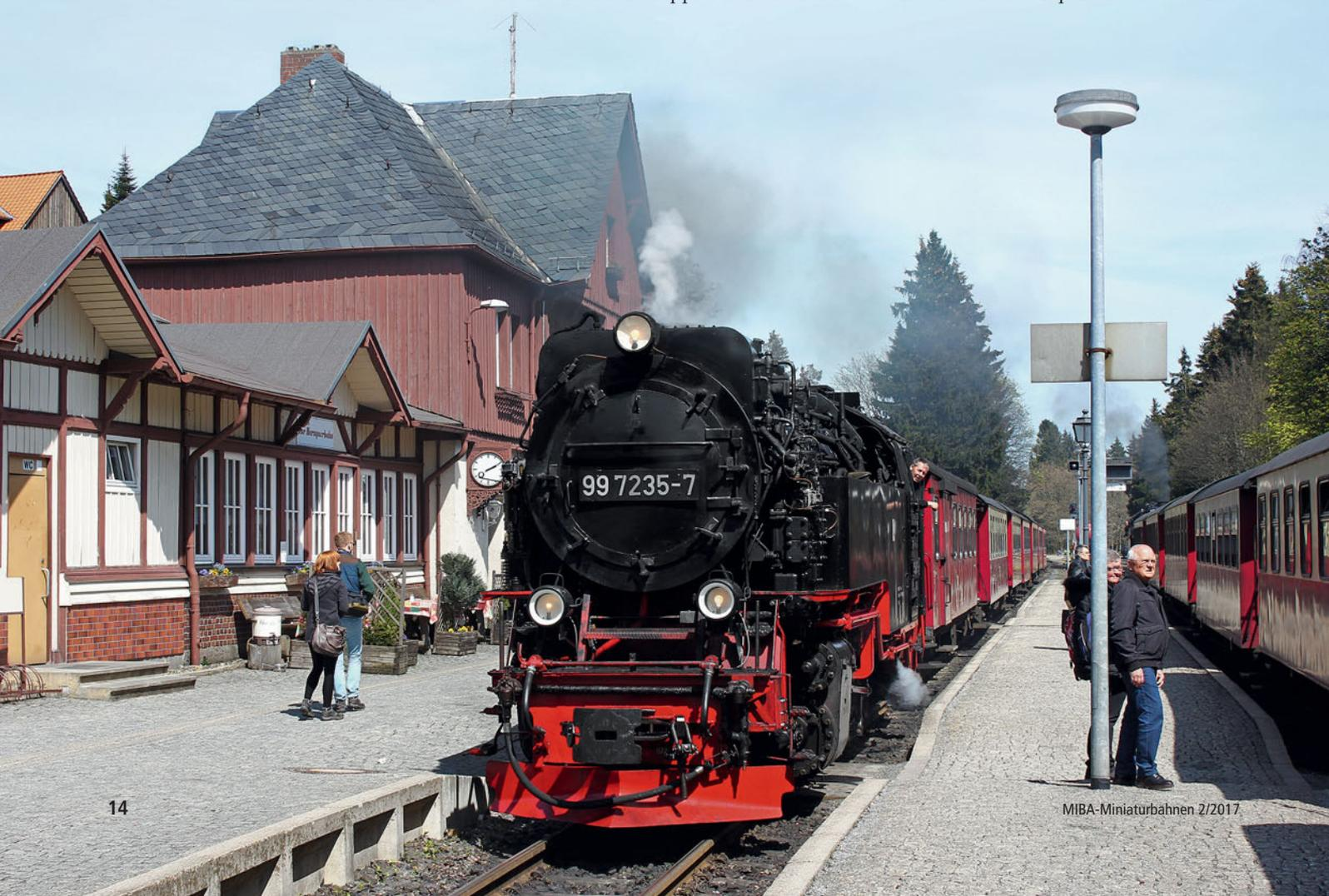
Wie an der Ziffer „0“ vor der Ordnungsnummer erkennbar ist, waren auch diese beiden Loks irgendwann zwischen 1976 und 1983 mit Ölhauptfeuerung ausgerüstet.
