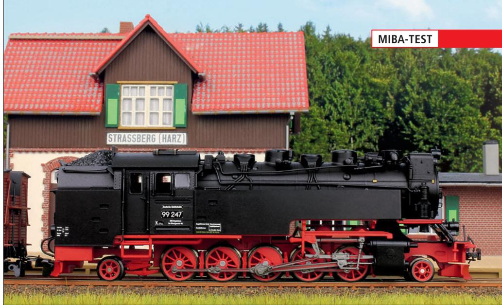
In der Seitenansicht ist das markante Aussehen des Vorbildes sofort wieder zu erkennen. Die Nachbildung der Heusinger-Steuerung besteht aus Kunststoff, ist sehr filigran und entspricht genauso dem Vorbild wie der freie Durchblick unter dem Kessel. Für die Variante der Neubaulok hat Tillig Position und Form der Tritte im geschweißten Wasserbehälter richtig umgesetzt. Die Anzahl der Speichen der Radsterne entsprechen ebenfalls dem Vorbild.
