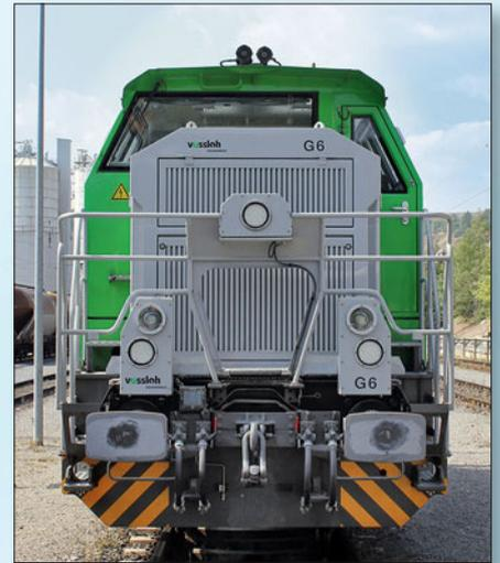
der aktuellen Crash-Norm zu erfüllen, müssen besondere Elemente zum Aufzehren der Aufprallenergie hinter den Puffern angebracht werden, was die Lok um 44 cm länger macht. Sie werden je nach Kundenwunsch und angestrebter Zulassung eingebaut.
