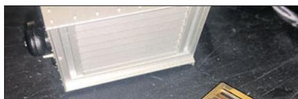
In den Vorbau muss genau passend zum Windklappenrahmen eine Öffnung gemacht werden. Bohren, sägen, feilen ...
