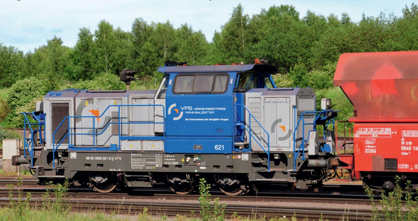
konnten aus den Standard-Baugruppen der Vossloh- Drehgestell-Lokomotiven entnommen werden. Die Radsätze sind scheibengebremst. Die Bremsen sind mit den Rädern axial beweglich.
