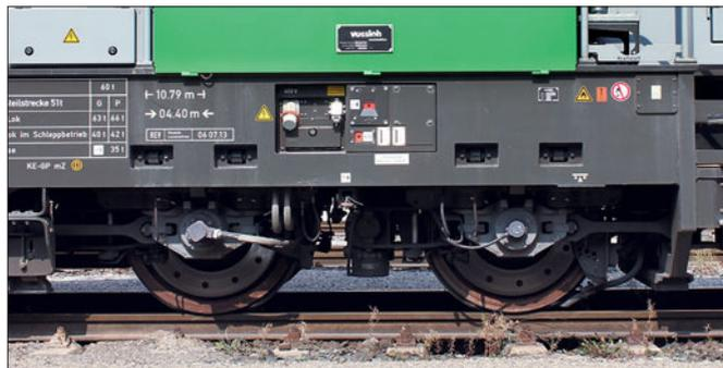
Die Loks besitzen scheibengebremste Radsätze. Über Lenker an den Radsatzlagern sind die Radsätze mit dem Fahrzeugrahmen verbunden. Gut erkennbar sind die Scheibenbremsen. Fotos: Sebastian Koch
