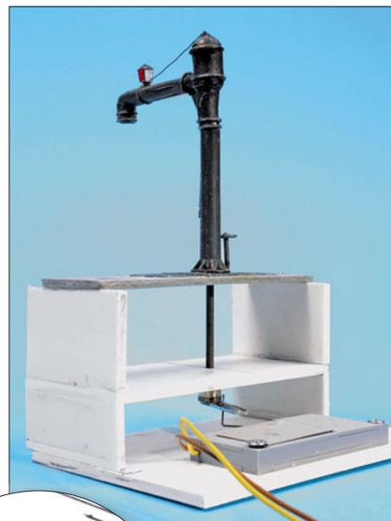
Der Antrieb ist mit dem Hebel der Wasserkranachse verbunden.
