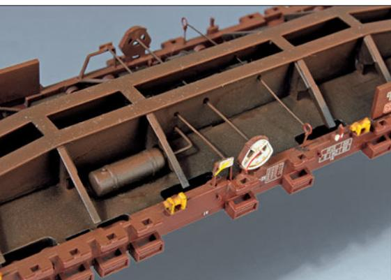
Die Bremsanlage von Udo Böhnlein wird wie beschrieben zusammengeleitet und anschließend mittig unter dem Wagenboden montiert.
