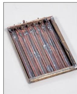
Der Windklappenkasten im zusammengebauten Zustand. Auf der Rückseite erkennt man hier noch rechts einen 0,5-mm-Stahldraht als Rückstellfeder und oben einen Mitnehmer. Der beabsichtigte Antrieb über einen Memorydraht erwies sich aber als zu schwach, sodass ein anderer Mitnehmer für den Linearservo angeklebt wurde.
