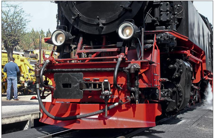
Foto oben: Die vordere Pufferbohle mit dem Heizdampfanschluss und dem großen Schneeräumer: Beide sind im klimatisch rauen Harzgebirge unverzichtbar. Neben dem Mittelpuffer ist die seitlich montierte Schraubenkupplung erkennbar.
