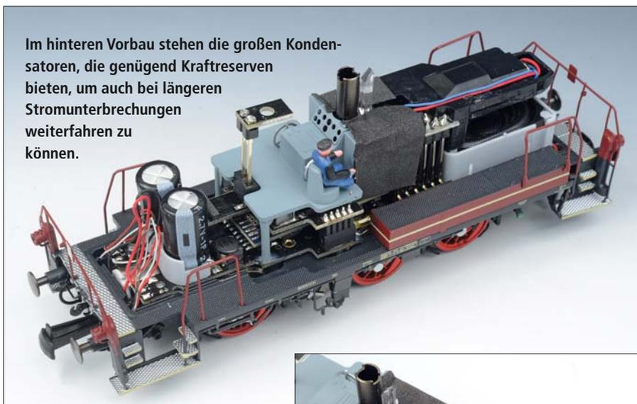
Im langen Vorbau ist der Rauchgenerator untergebracht. Damit der Ausstoß effektiv erfolgen kann, sorgt ein kleiner Gebläsemotor für einen konstanten Luftzug innerhalb der Raucheinheit. Unten: Einige besonders exponierte Teile liegen – gleichwohl sie bereits ...
