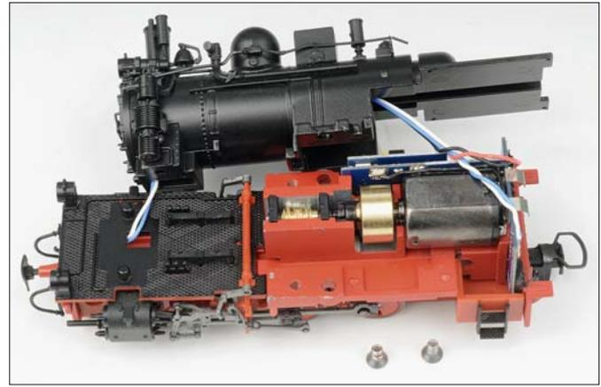
Der Motor verfügt über ein „Schwungmässchen“; das Antriebsmoment wird per Schnecke grundsollide auf die mittlere Achse weitergegeben.
