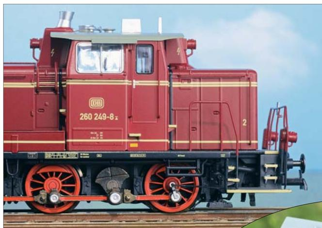
Auch am kurzen Vorbau finden sich sämtliche Griffstangen und Bühnengeländer. Interessant die kleine Gegenkurbel am dritten Radsatz mit einem beweglichen Gestänge zur Fettpresse der Spurkranzschmierung.
