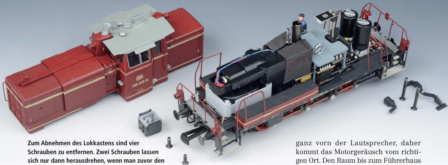
Zum Abnehmen des Lokkastens sind vier Schrauben zu entfernen. Zwei Schrauben lassen sich nur dann herausdrehen, wenn man zuvor den Dofa-Ofen und einen Bremszylinder abzieht.
