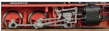
Die feinen Treib- und Kuppelstangen sowie die Steuerung (mit vorn geteilter Schieberstange) verdienen Anerkennung.
