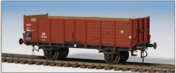
Dieser Om 12 erhielt noch ergänzend Griffstangen und eine Wagenkastenstütze unter der Tür.
