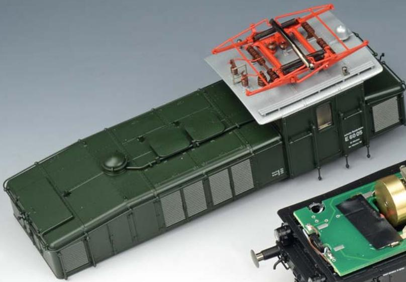
Mit nur zwei, diagonal versetzt angeordneten Schrauben ist das Lokgehäuse auf dem Fahrwerk befestigt. Nach deren Lösen lässt sich beides ohne Hakeln voneinander trennen. Beim Aufsetzen muss man aber die vier Kontaktlaschen für die Führerhausbeleuchtung und die jeweils dritten Spitzenlichter beachten.
