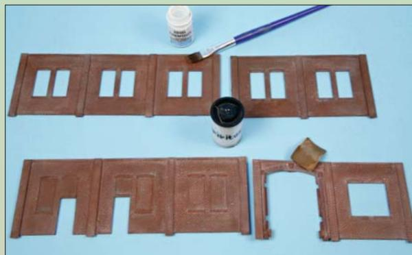
Mit dem „Fugenfüller von Modelmates lassen sich recht einfach Mörtelfugen anlegen. Für eine gegebenenfalls erforderliche Verdünnung ist Spiritus geeignet.
