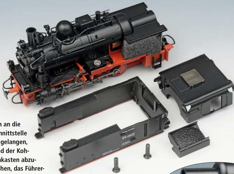
Um an die Schnittstelle zu gelangen, sind der Kohlenkasten abzuziehen, das Führerhaus abzuklipsen und die Wasserkästen abzuschrauben.
