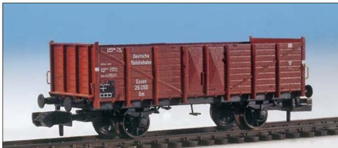
Auf der Basis des Om 12 von Fleischmann entsteht der Om 04. Trittstufe und Griffstangen sind bereits ergänzt.
