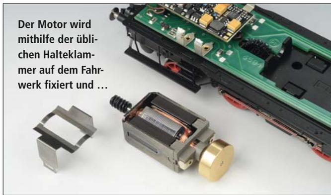
Der Motor wird mithilfe der üblichen Halteklammer auf dem Fahrwerk fixiert und ...
