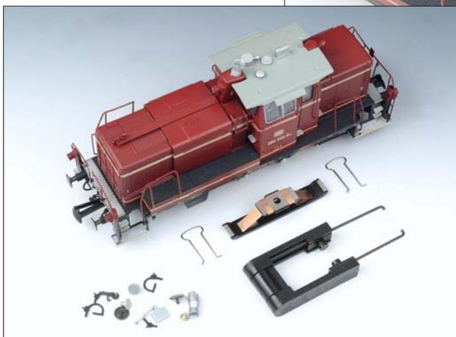
... am Modell montiert sind – zusätzlich bei. Außerdem kann der Kunde noch die vorgebogenen Sensorbügel für das Kurvenquietschen und je nach Gleissystem den Mittelschleifer montieren. Der große Griff wird zum Abziehen des Mittelschleifers benötigt.
