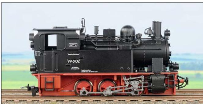
Auch Vorseienexemplare der 99 6101, der an den kürzeren Wasserkästen leicht erkennbaren Heißdampfversion, wurden bereits vorgestellt.
