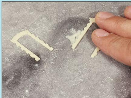
In kreisenden Bewegungen auf feinem Schleifpapier werden die gegossenen Bauteile auf die erforderliche Stärke reduziert.
