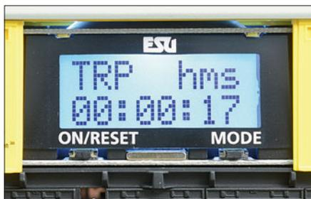
TRP schließlich addiert die Fahrzeiten in Stunden:Minuten:Sekunden seit dem letzten Reset und TRK zeigt die Spitzenspannung am Gleis an (hier 16,1 Volt, ausgegeben von einer Lenz-Zentrale). Fotos: MK
