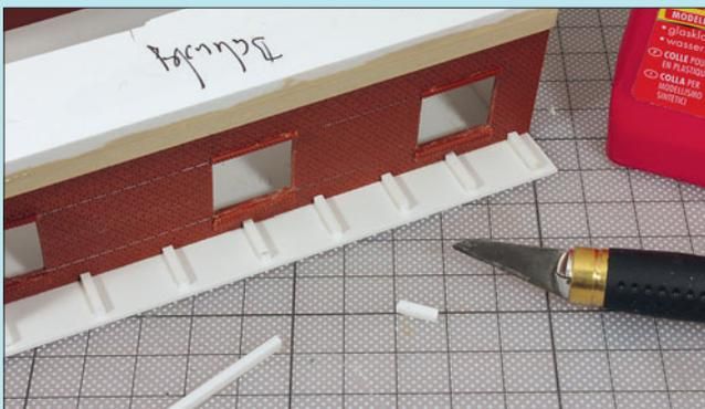
Die Dachspanten entstanden durch kleine Kunststoffprofile, die passend abgelängt und von unten an den Dachvorstand geklebt wurden. Nachträglich erhalten sie die passende Farbgebung.
