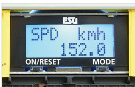
Hinter den seitlichen Leuchtstofflampen liegen auf beiden Seiten LEDs. Auch die Stirnlampen sind beleuchtet, wobei der Lichtwechsel weiß/rot von der digital eingestellten Fahrtrichtung bestimmt wird. Im Modus „SPD“ wird die aktuelle Geschwindigkeit angezeigt, wobei die Freeze-Funktion nicht nur für's Fotografieren praktisch ist ... „MAX“ zeigt das höchste bisher gefahrene Tempo.
