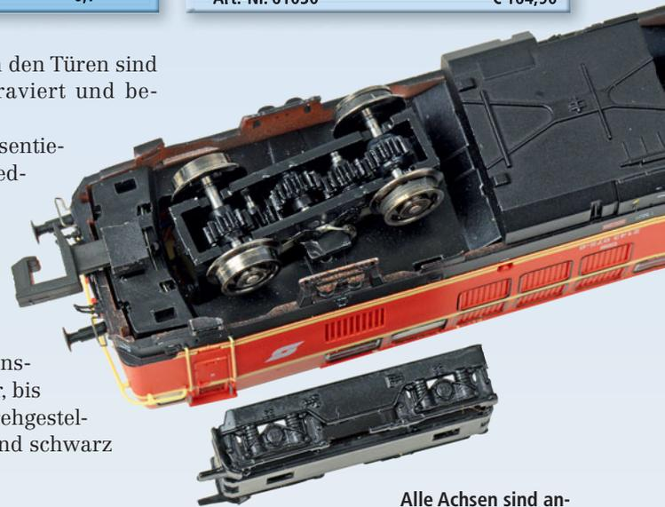
Alle Achsen sind angetrieben und eine der inneren trägt Haftreifen zur Zugkraftverstärkung. Die KK-Kulisse ist kompakt hinter der Pufferbohle untergebracht.
