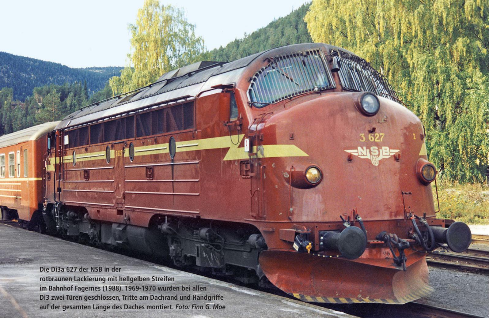
Die Di3a 627 der NSB in der rotbraunen Lackierung mit hellgelben Streifen im Bahnhof Fagernes (1988). 1969-1970 wurden bei allen Di3 zwei Türen geschlossen, Tritte am Dachrand und Handgriffe auf der gesamten Länge des Daches montiert. Foto: Finn G. Moe
