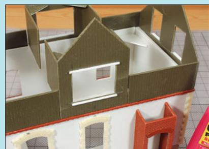
Die Fensterrahmen im holzverkleideten Obergeschoss bestehen aus dünnen Polystyrolstreifen.
