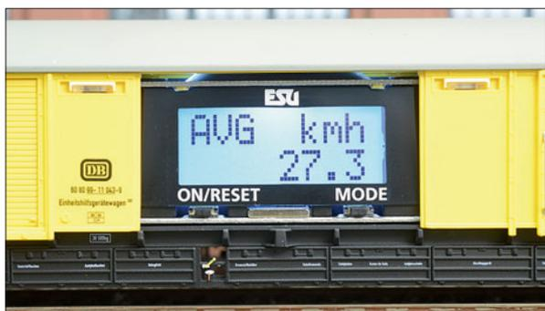
**74** Bezeichnenderweise in einem Dienstfahrzeug bringt ESU nützliche Messtechnik. Ausgerüstet mit allerlei Elektronik vermag es unter anderem bei der Ermittlung einer vorbildgerechten Modellgeschwindigkeit helfen. Martin Knaden stellt den gelben Engel vor. *Foto: MK*
