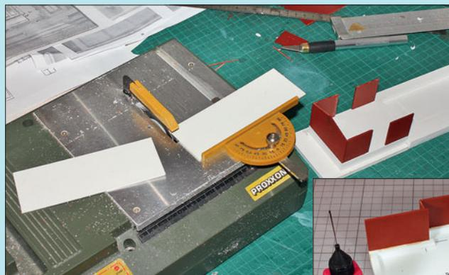
Die Außenwände wurden an der Tischkreissäge mit einem Anschlag rechtwinklig zugeschnitten.
