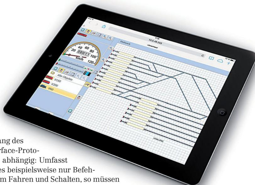
umfang des Interface-Protokolls abhängig: Umfasst dieses beispielsweise nur Befehle zum Fahren und Schalten, so müssen komplexere Funktionen – zum Beispiel das Einstellen von Fahrstraßen – von den jeweiligen Apps selbst unter Rückgriff auf die elementaren Befehle des Protokolls realisiert werden.
