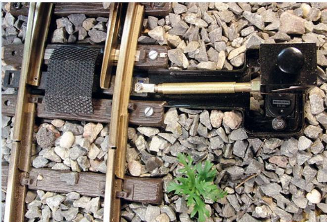
Das unten abgebildete Montageblech wird an den Schwellen der LGB-Weiche angeschraubt. Der Servo wird durch den aufgelöteten Messingstreifen gegenüber Schotter und sonstigem geschützt. Die Stellstange ist eine Art gefedertes Teleskoprohr, mit dem die Weiche gestellt wird, das aber auch ein Aufscheiden der Weiche erlaubt.
