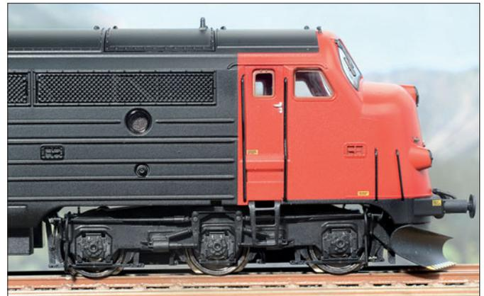
Die Nachbildung der Drehgestelle entspricht ebenfalls dem norwegischen Vorbild. Dies betrifft in erster Linie die zu jedem Radsatz gehörenden Bremszylinder oberhalb des Radsatzlagers. Letztere wurden ebenso freistehend ausgeführt, wie die Bremsklötze in Radebene mit dem zugehörigen Gestänge. Auch die Sandfallrohre an den jeweils äußeren Achsen fehlen nicht.
