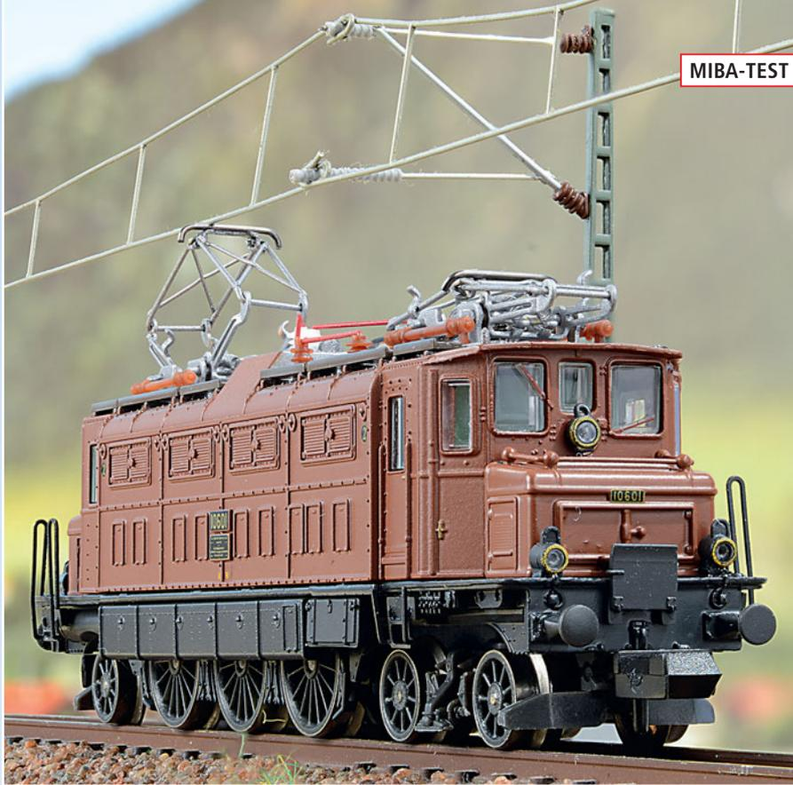
Über der Apparateseite sind die beiden großen Luftspulen montiert, die anfangs auf dem Dach untergebracht waren. Auch das Übergangsblech ist ein Detail der frühen SBB-Epoche II. *Fotos: gp*
