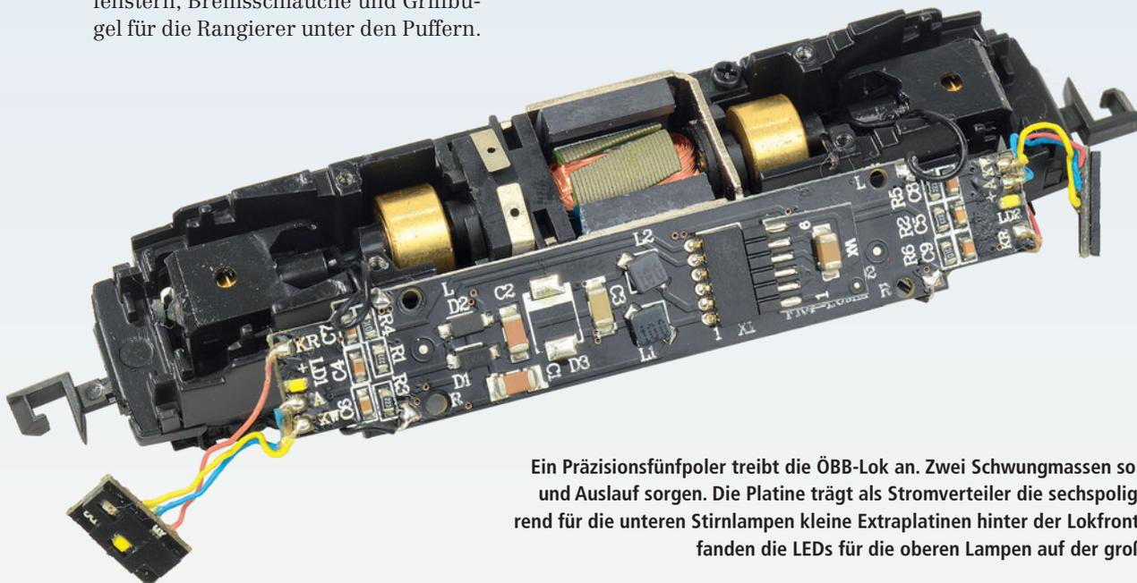
Ein Präzisionsfünfpoler treibt die ÖBB-Lok an. Zwei Schwungmassen sollen für Fahrdynamik und Auslauf sorgen. Die Platine trägt als Stromverteiler die sechspolige Schnittstelle. Während für die unteren Stirnlampen kleine Extraplatten hinter der Lokfront untergebracht sind, fanden die LEDs für die oberen Lampen auf der großen Lokplatine Platz.
