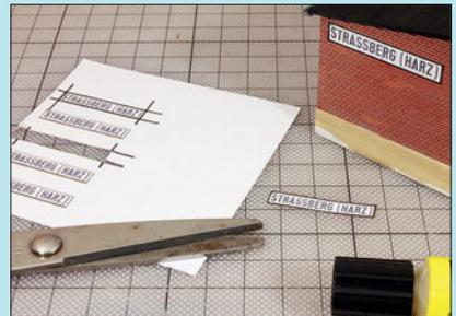
Die Bahnhofsschilder entstanden fotografisch. Sie wurden am PC in die richtige Größe gebracht und ausgedruckt. Der Rahmen wurde mit einem Fineliner gezogen, bevor die Schilder ausgeschnitten wurden.
