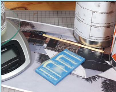
Durch Abformen mit Resin-Gießmasse können von der Kautschukform nun etliche Abgüsse erstellt werden.
