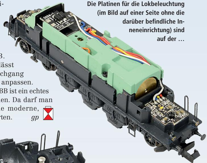
... Unterseite mit Kontakt-flächen für die Pilzkontakte der Vorläufer ausgestattet.
