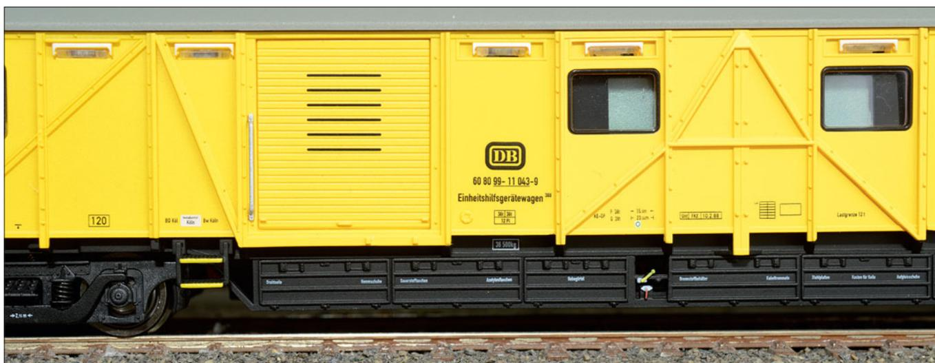
Das Modell ist im Hauptanschriftenfeld als Einheitshilfsgerätwagen (Bauartnummer 388) beschriftet. Die übrigen Anschriften sind deutlich kleiner, gleichwohl gestochen scharf gedruckt. Die Vorbild-Höchstgeschwindigkeit von 120 km/h gilt zum Glück nicht für das Modell ...
