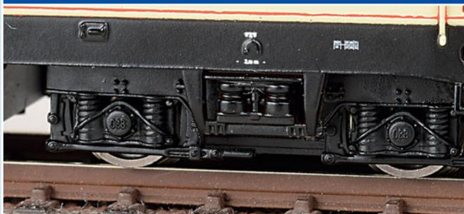
Detailliert aber nicht extrem plastisch sind die Drehgestellblenden gestaltet. Die Kastenabstützung ist Teil des Gehäuses.
