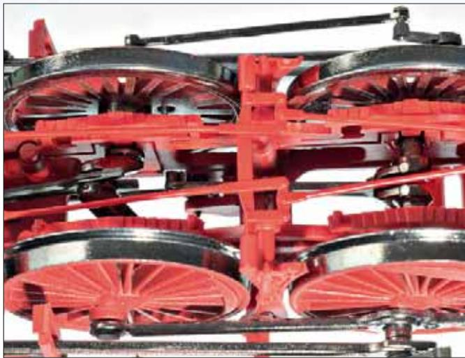
Der Clou des Modell versteckt sich im filigranen Rahmen: Die vordere Kuppelachse ist gekröpft, sodass sich die innere Treibstange vorbildgerecht bewegt. Auch die nachfolgende Achse hat eine kleine Kröpfung, sodass sogar der Schwingenantrieb beweglich ist: Premiere für ein Großserienmodell!
