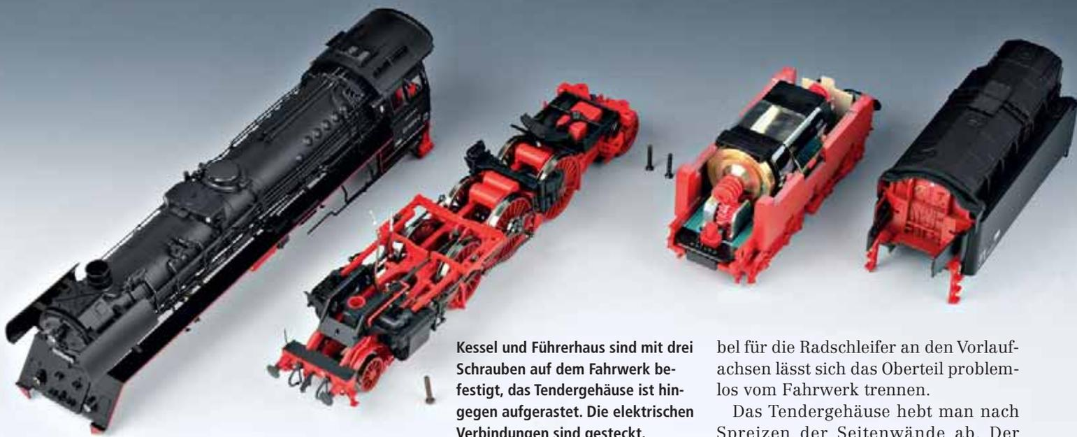
Kessel und Führerhaus sind mit drei Schrauben auf dem Fahrwerk befestigt, das Tendergehäuse ist hingegen aufgerastet. Die elektrischen Verbindungen sind gesteckt.
