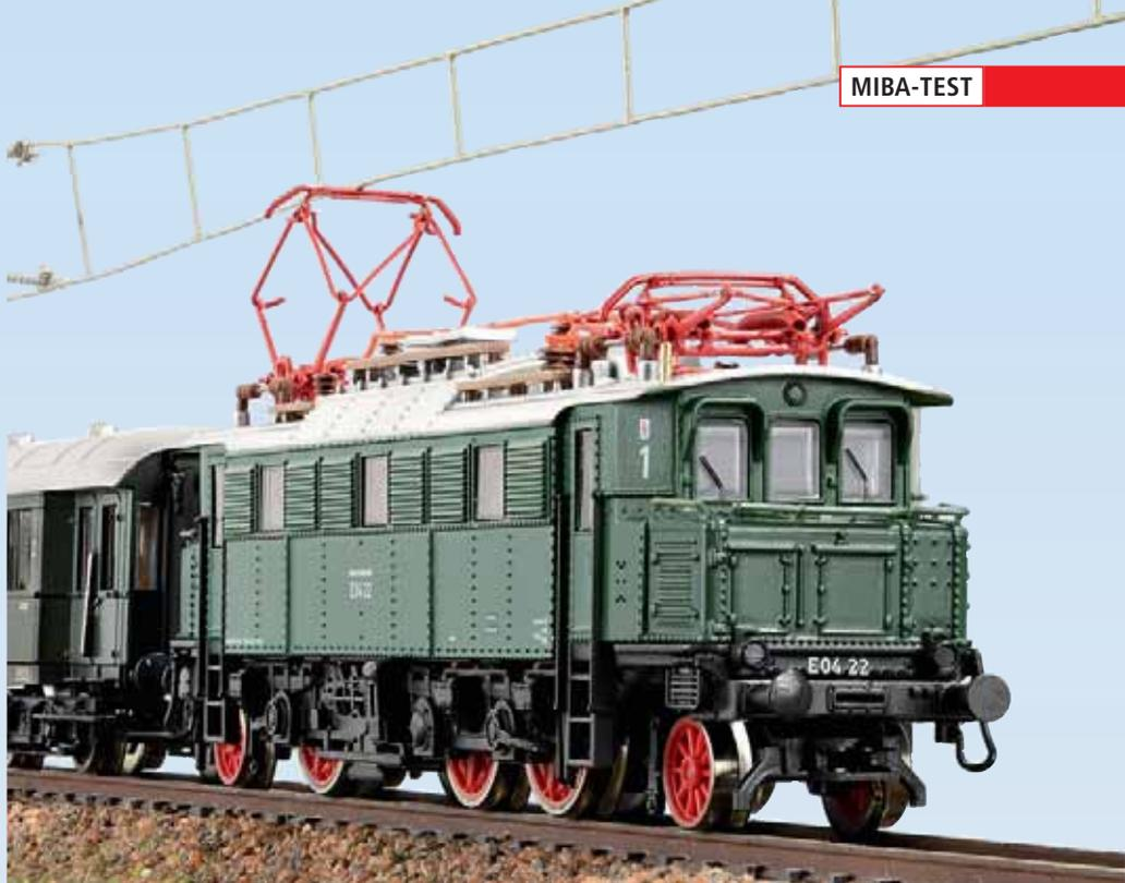
Fein und dennoch stabil erlauben die Pantographen den echten Oberleitungsbetrieb. Beispielfhaft liegt nur einer der Pantos am Fahrdrabt. Fotos: gp
