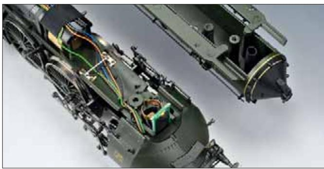
In der Rauchkammer der Lok verbirgt sich der Steckplatz für einen optionalen Rauchgenerator. Damit der Rauch auch wirklich den korrekten Weg nach außen findet, ist ein flexibler Schlauch im Schlot eingesetzt.
