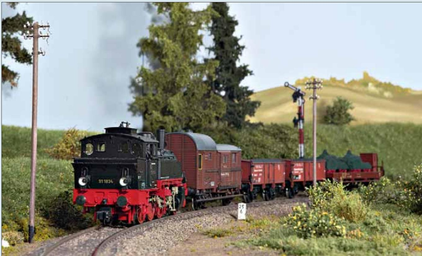
Leistungsfähig und mit einer Höchstgeschwindigkeit von immerhin 65 km/h ließ sich die Baureihe 91 sowohl vor Nahgüterzügen auf Hauptbahnen (im Foto oben bei der Einfahrt nach Bladiau) als auch im Rangierdienst (im Foto unten vor dem Stellwerk von Bladiau) einsetzen.
