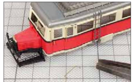
Das Dachgeländer wird gebogen und in die Bohrungen am Gepäckträger geklebt (oben links). Aus Draht biegt man die Griffstangen und klebt sie neben die Türen (oben rechts). Das Fahrwerk erhielt eine neue Verdrahtung und einen Digitaldecoder.
