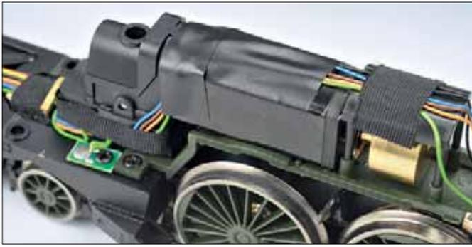
Der schlanke Motor liegt im zweiten Kesselschuss. Von der Schnecke aus geht eine Zahnradkette durch die Feuerbüchse und führt ...
