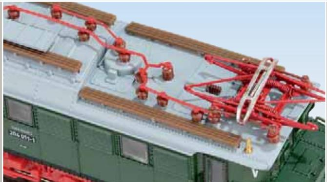
Bei der DR-Variante wurden die Pantos nach außen und der Ölhauptschalter zur Fahrzeugmitte verschoben.
