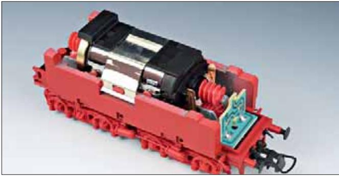
Der große, zentral gelagerte Motor hat fünf Polwicklungen und eine Schwungscheibe mit großem Durchmesser. Er treibt über zwei Schnecken-Stirnrad-Getriebe ...
