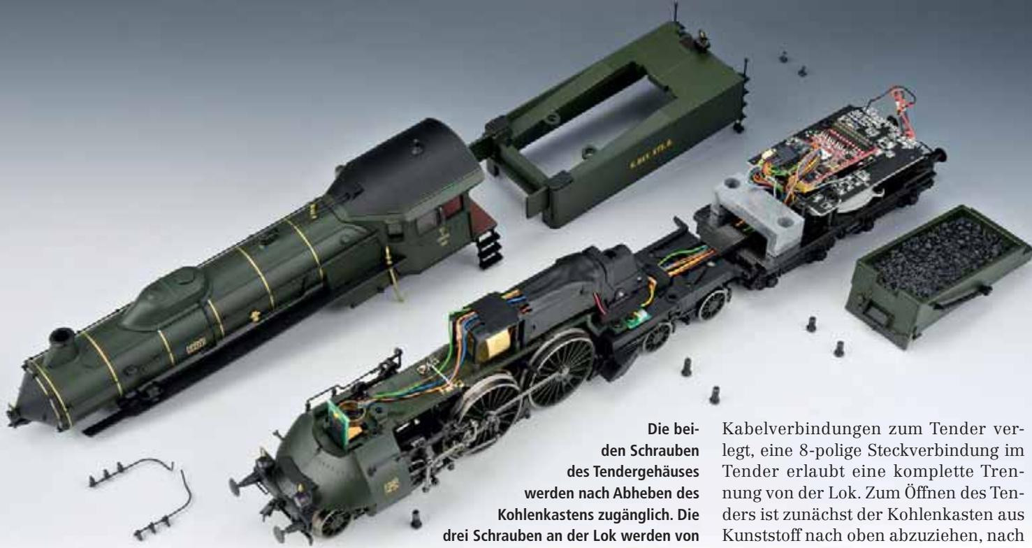
Die beiden Schrauben des Tendergehäuses werden nach Abheben des Kohlenkastens zugänglich. Die drei Schrauben an der Lok werden von unten gelöst, wobei die vordere bedingt durch das Drehgestell nur mühsam zugänglich ist.
