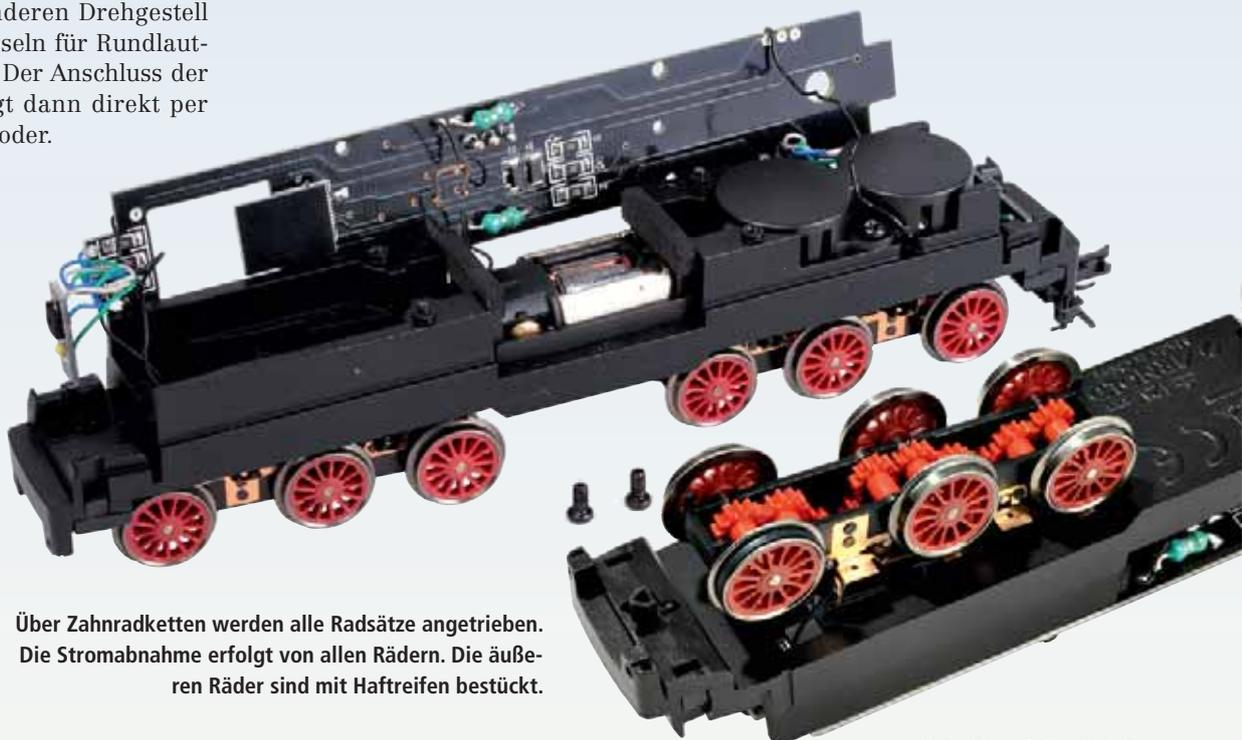
Über Zahnradketten werden alle Radsätze angetrieben. Die Stromabnahme erfolgt von allen Rädern. Die äußeren Räder sind mit Haftreifen bestückt.
