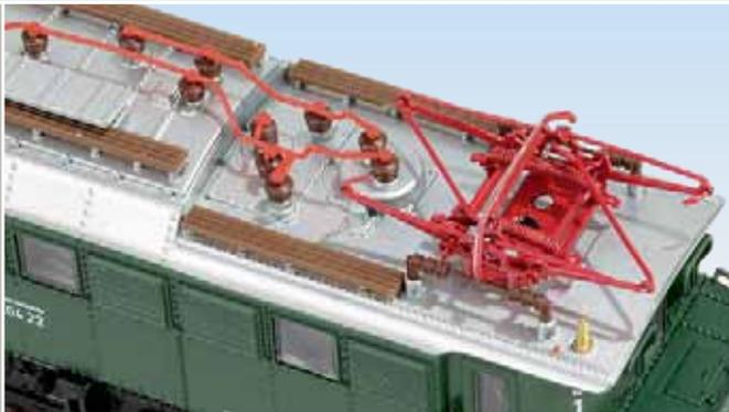
Die Dachpartie der DRG- und der DB-Ausführung gleichen sich. Beide tragen auch den HISE-2-Panto mit nur einem Schleifstück.
