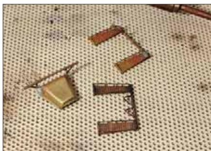
Die Halterungen für die Gepäckkörbe lötet man mit einer Flamme an die Vorbauten und an die Körbe (oben links). Es ist darauf zu achten, dass die Halterungen senkrecht montiert sind. Die Bügel biegt man dann passend für den Vorbau zurecht (oben rechts).
