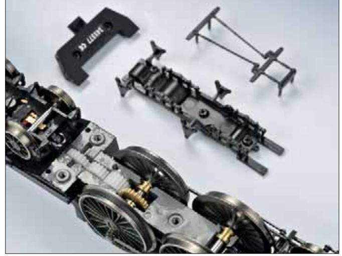
... im Rahmen bis zur Kuppelachse. Deren Räder tragen beidseitig Haftreifen, was eine ausgezeichnete Zugkraft ergibt. Fotos: MK
