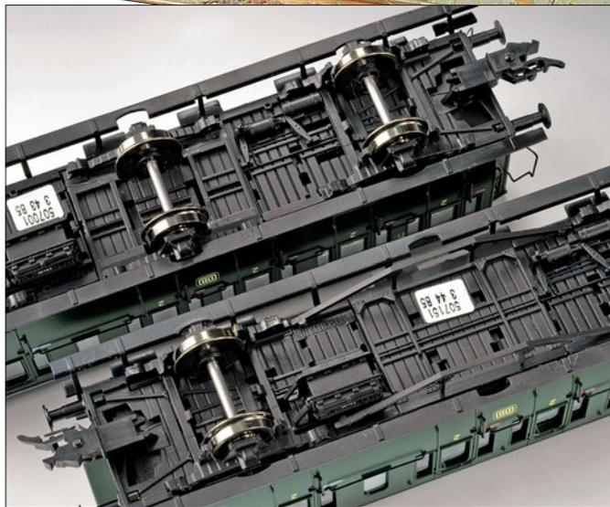
Links: Die Fahrwerke mit dritter Achse oder Sprengwerk.
