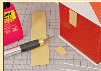
Türen und Luken entstanden aus Bretterplatten, die Scharniere wurden mit Polystyrolstreifen angeklebt.
