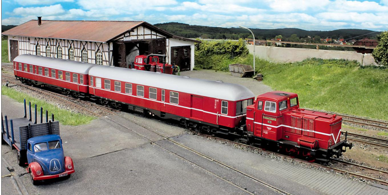
Der selbstgebaute Lokschuppen wird gerade von Lok VL 11 und ihrer Wendezuggarnitur passiert. Das Lokschuppen-Grundmodell ist aus Sperrholzplatten gefertigt, die Fachwerkstreifen sind aus Holz und die Gefache wurden verputzt. Das Original von Rolf Köstner zeigt, wie dicht Holger Kiesch am Vorbild gebaut hat.
