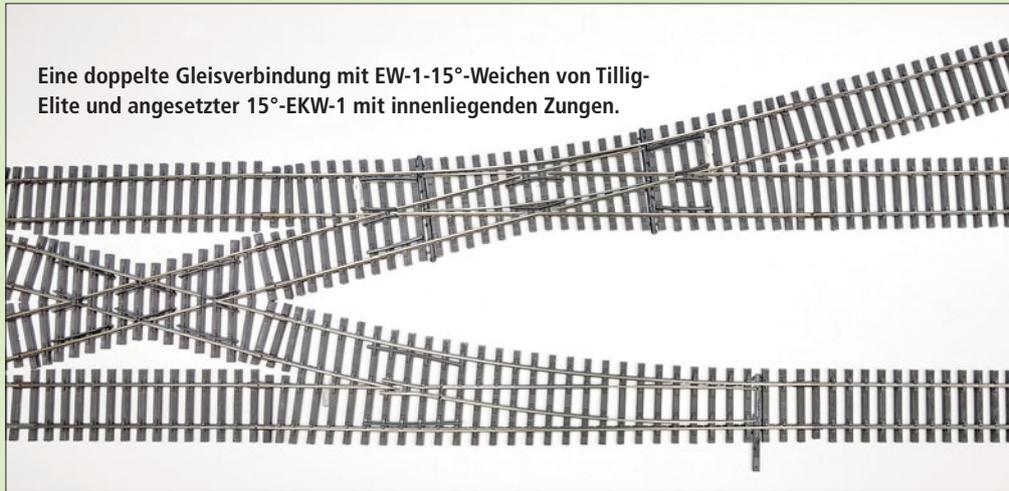
Eine doppelte Gleisverbindung mit EW-1-15°-Weichen von Tillig-Elite und angesetzter 15°-EKW-1 mit innenliegenden Zungen.
