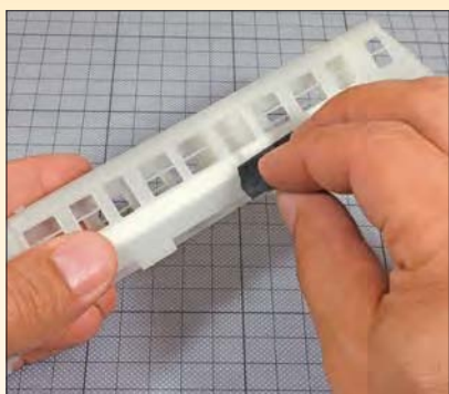
Unebenheiten auf glatten Oberflächen schleift man vor dem Lackieren glatt.
