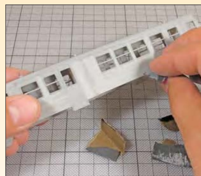
Mit Schleifpapier glättet man – wo möglich – die Oberflächen vor der Farbgebung.
