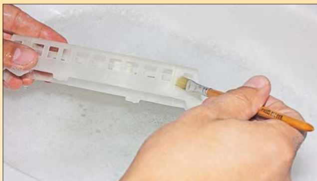
Die klebrige Oberfläche der Kunststoffmodelle sollte mit lauwarmen Seifenwasser und einem Pinsel gereinigt werden.
