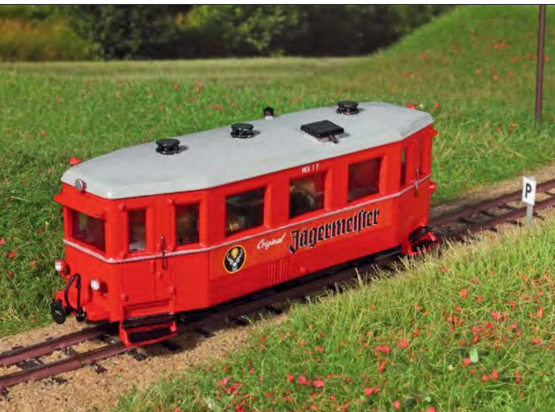
Der fertige T7 der Mittelbadischen Eisenbahn auf dem typischen einfachen Oberbau, wie er auf zahlreichen Neben- und Schmalspurbahnen zu finden war.
