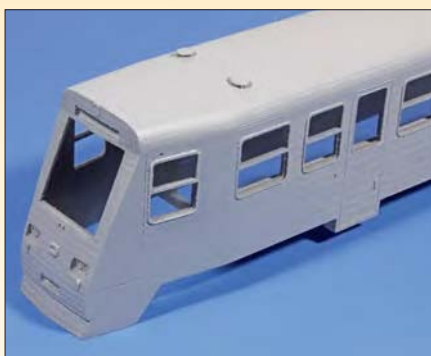
Die meisten Unebenheiten erkennt man erst nach erfolgter Grundierung.
