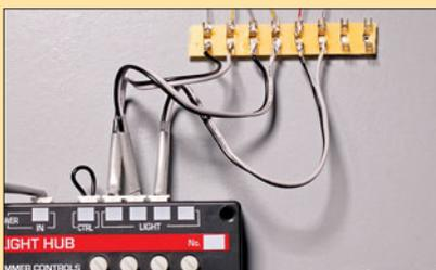
Um die nicht von Woodland/Noch stammenden Lichtquellen anzuschließen, wurden deren Anschlussdrähte über Lötleisten an die genormten Stecker des „Just Plug“-Systems angeschlossen.
