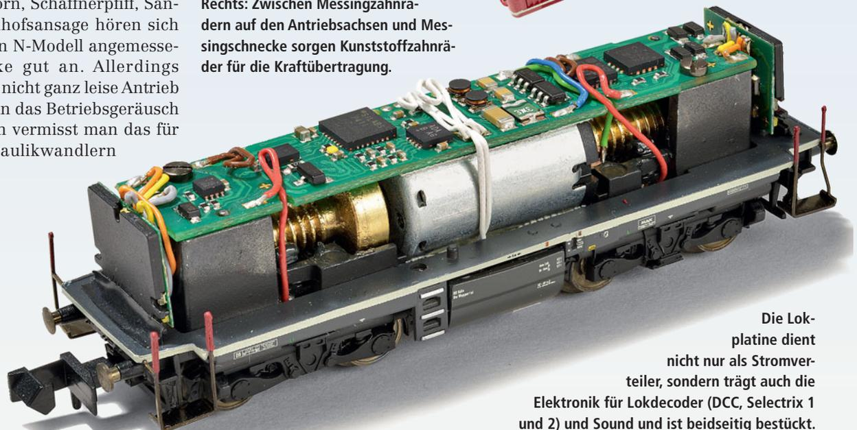
Die Lokplatte dient nicht nur als Stromverteiler, sondern trägt auch die Elektronik für Lokdecoder (DCC, Selectrix 1 und 2) und Sound und ist beidseitig bestückt.
