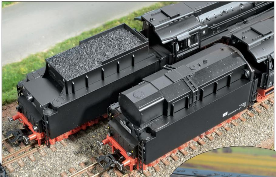
Kohlen- wie Öltender im direkten Vergleich. Auf einem Metalluntergestell sind die beiden Brennstoffbehälter jeweils aus Kunststoff. Auch die Kesselarmaturen unterscheiden sich auf beiden Seiten.
