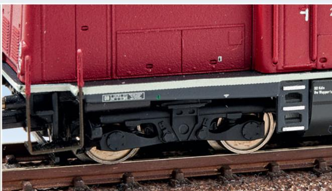
Die Drehgestellblende unter dem kurzen Vorbau zeigt sich ohne zusätzliche Ausrüstung; beachtenswert die Wartungsklappen im Vorbau.
