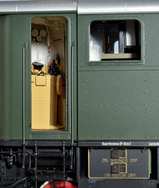
Drückt man die Führerstands Türen auf, fällt der Blick auf die perfekte Innengestaltung des Führerstandes. Hier ebenfalls zu sehen: der Werkzeugkasten mit den verborgenen Schaltern. Die winzigen Knebel sind demonstrativ wieder nach unten gedreht.
