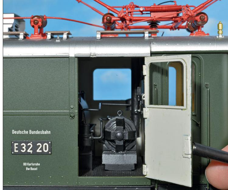
Im abgesenkten Zustand liegen die Stromabnehmer der Bauart SBS 9 sehr schön flach auf dem Dach. Hier gut zu sehen: Das Trennmesser mit seiner kulisenförmigen Anlenkung.
