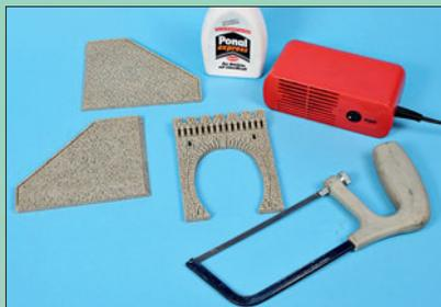
Mit einer Eisensäge lassen sich die Teile zurechtschneiden. Mit einem Haartrockner erwärmt, sind sie biegsam. Zum Verkleben eignet sich u.a. Weißleim.
