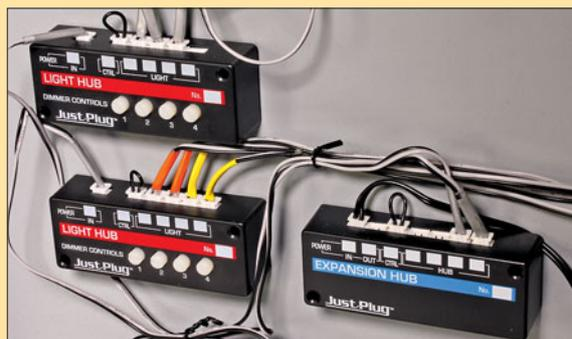
ckernetzteil anschließen. Die LEDs sind bereits mit Kabeln versehen und können über kleine Stecker direkt an die „Light Hubs“ angeschlossen werden; dazu gibt es passende Verlängerungskabel.
