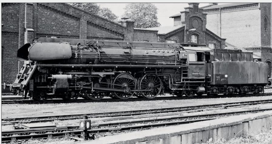
geplant. Die HvM entschied, nur 35 Maschinen zu modernisieren. Mit 01 535 verließ die letzte Lok am 31. Mai 1965 das Raw Meiningen. 28 Maschinen erhielten ab Werk eine Ölhauptfeuerung.
