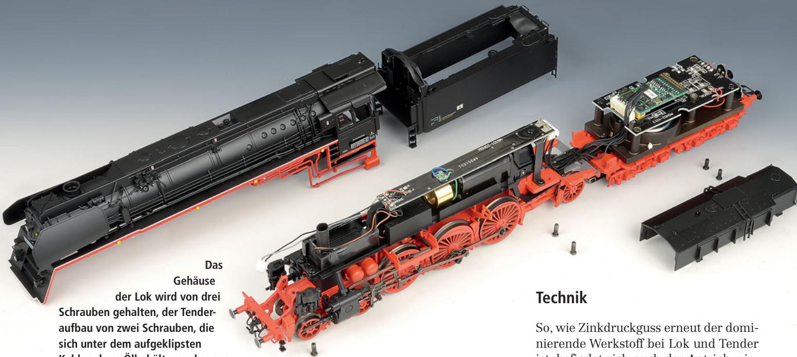
Das Gehäuse der Lok wird von drei Schrauben gehalten, der Tenderaufbau von zwei Schrauben, die sich unter dem aufgeklipsten Kohlen- bzw. Ölbehälter verbergen.
