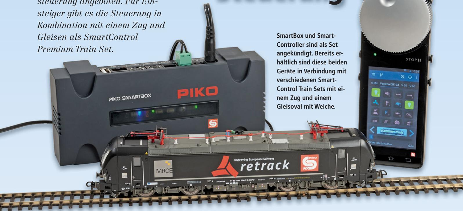
Mit der Kombination aus Smartphone-basierendem Funkhandregler und einer Blackbox als DCC-Zentraleinheit bietet Piko eine attraktive Digitalsteuerung an, die moderne Technik mit den Bedürfnissen der Modellbahner verbindet. Diese Kombination ist auch eine ansprechende Alternative zur Mobile Control II von ESU, die als Basis eine ECoS-Zentrale benötigt.
