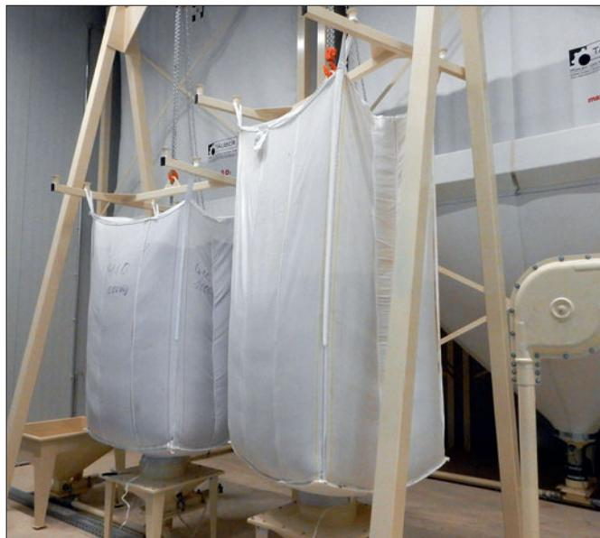
Das Malz wird heutzutage in „Big Sacks“ in den Brauereien angeliefert. Die Säcke werden oberhalb der Einfallstutzen an extra dafür hergestellten Gestellen aufgehängt. Von dort aus wird das Malz entweder pneumatisch oder mit Förderschnecken zur Verschrotung bzw. in den Braubottich befördert.
