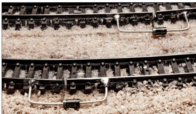
Für den sicheren Halt in den Endbahnhöfen werden an den Gleisenden vor den Prellböcken Dioden installiert, die eine Gleistrennung überbrücken. Ein Weiterfahren in Richtung Prellbock ...
