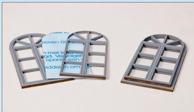
Die Fenster sind gleichfalls aus MDF gelasert und haben auf der Rückseite eine Klebebeschichtung. Links die drei Teile eines Fensters in der Reihenfolge des Aufeinanderklebens, rechts das Fertigteil.
