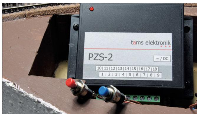
Das Programmieren der Haltedauer und der Abbrems- und Beschleunigungszeiten für jeden Bahnhof bzw. Haltepunkt erfolgt über Taster, die mit den Anschlussklemmen verkabelt sind.
