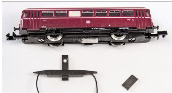
Die Magnetkontakte von Viessmann passen nach Entfernen der Befestigungslaschen zwischen die Gleisprofile. Die Schwellen müssen jedoch an dieser Stelle entfernt werden. Die flachen Magneten finden unter den Fahrzeugen ihren Platz.
