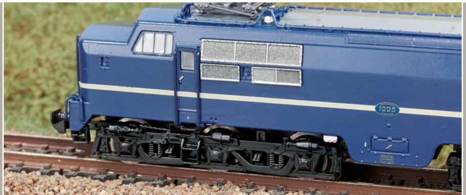
Die Drehgestelle sind detailreich mit Bremsklötzen in Radebene nachgebildet. Fotos: gp
