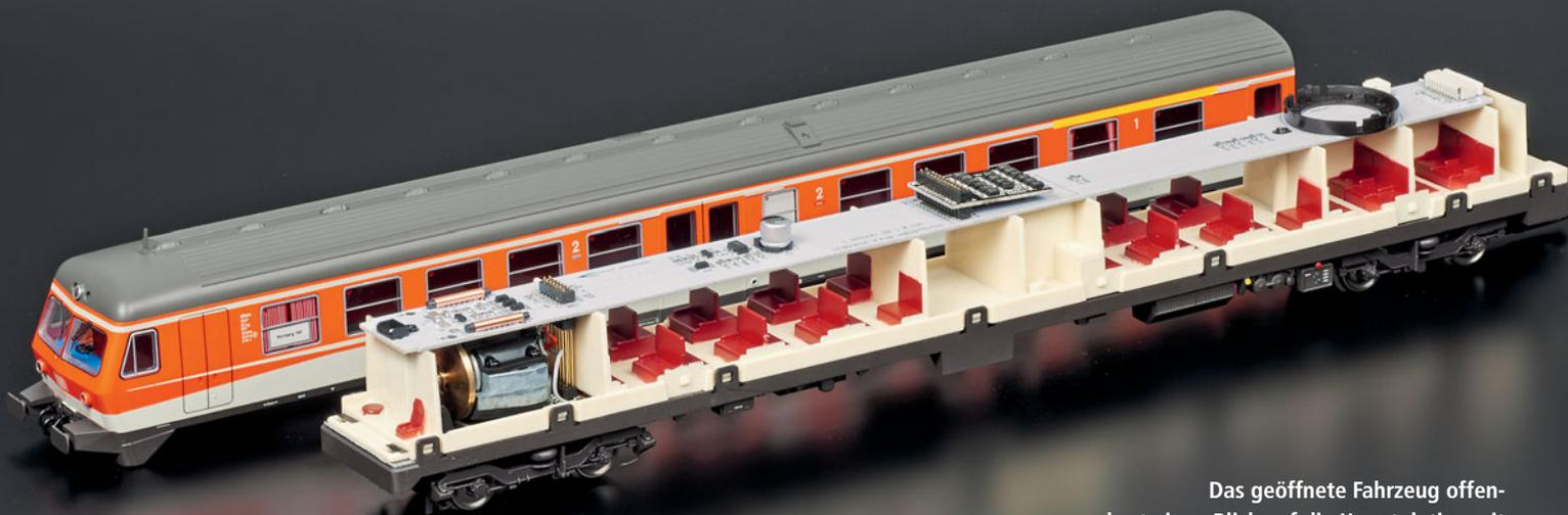
Das geöffnete Fahrzeug offenbart einen Blick auf die Hauptplatine mit 21MTC-Schnittstelle und der Lautsprecheraufnahme.
