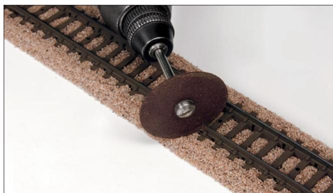
Mit einer Trennscheibe sind die Gleistrennungen für die Pendelzugsteuerung schnell und unkompliziert hergestellt. Die einzelnen Gleisabschnitte werden direkt mit der Pendelzugsteuerung verbunden.
