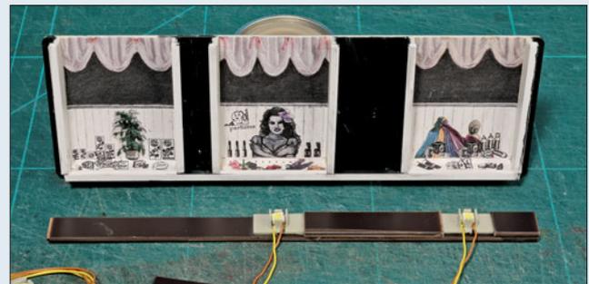
Die Abdeckung besteht aus zwei Lagen Kunststoff. Ein Streifen ist durchgängig und so lang wie die Fensterdekoration. Auf diesen klebt man die LEDs und ergänzt die Zwischenräume mit Füllstücken.
