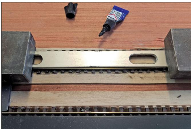
Um ein Verschieben oder Verwinden des Gleises ohne die stabilisierenden Schwellen zu verhindern, wurde das Gleis mit einer Alulehre ausgerichtet und die Kleisen mit Sekundenkleber fixiert. Danach erfolgte die weitere Gestaltung mit Spachtelmasse und Farbe.
