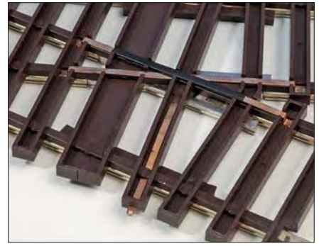
In den Schwellen und Verbindungsstegen sind die Kontaktpolarbahnen und Anschlussfahnen der Herzstückpolarisierung untergebracht.
