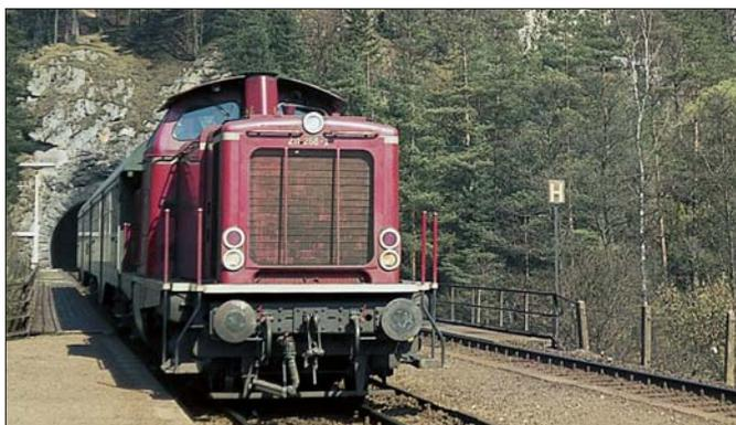
... während 212 und 213 – hier 213 340 in Boppard bei einer Sonderfahrt – etwas länger gebaut sind. Die 213 haben zudem die Steilstreckenausrüstung mit hydrodynamischer Bremse. *Fotos: Kurt Eckert*
