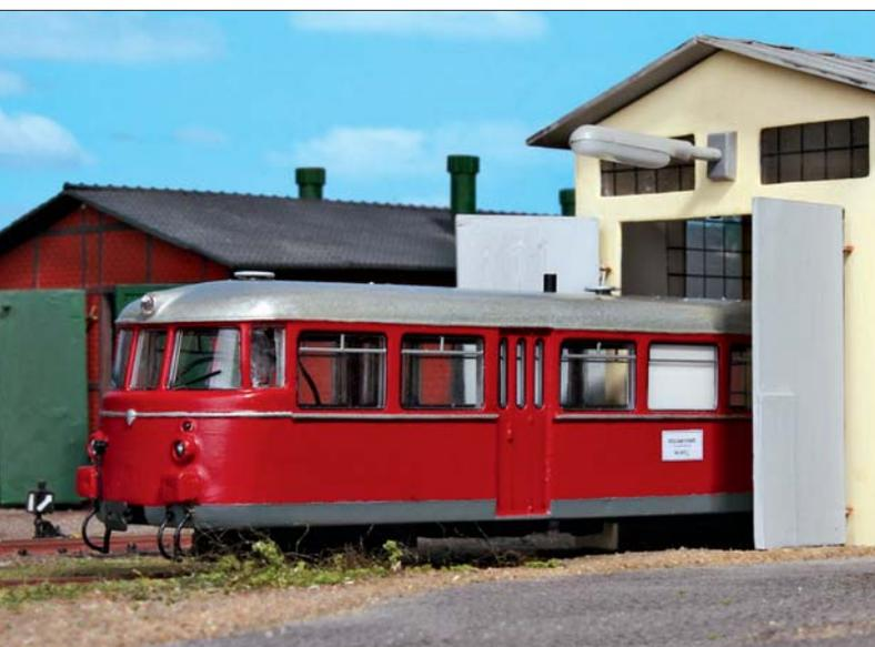
In einer modernen Triebwagenhalle macht der kleine Schmalspurtrieb-wagen aus den 1960er-Jahren eine gute Figur. Die Türanordnung musste bei der Schmalspurausführung nach innen verschoben werden, um Platz für die Drehgestelle zu schaffen.
