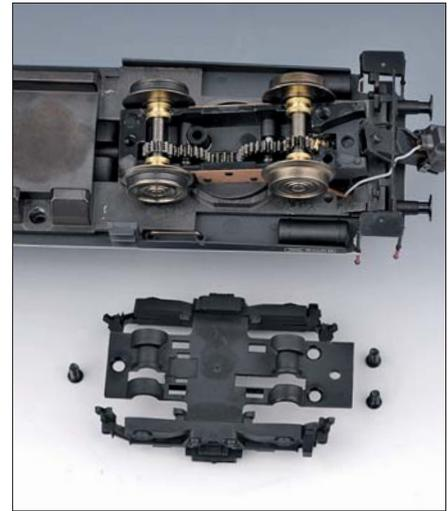
Fast die gesamte Elektrik ist auf einem Kunststoffträger untergebracht, der zugleich den Motor in seiner Mulde hält. Rechts der Getriebekasten von der Unterseite. Seitlich liegen die Kabel zu den Telex-Kupplungen. Fotos: MK, dh
