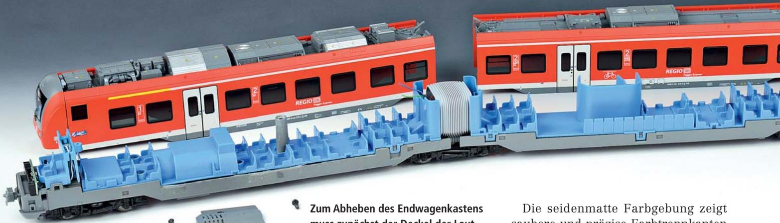
Zum Abheben des Endwagenkastens muss zunächst der Deckel der Lautsprechermulde abgeschraubt werden.
