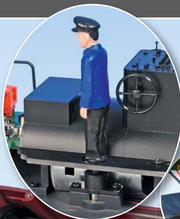
Links: Der Lokführer wird von einem kompakten elektromagnetischen Antrieb gedreht.
