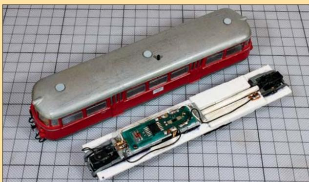
Der geänderte Wagenkasten des Schmalspurtriebwagens und der kostengünstig selbst gebaute Antrieb werden montiert und miteinander verschraubt.
