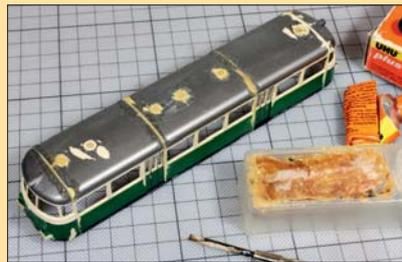
Die Spalten der Verklebung werden mit Zwei-Komponentenkleber verschlossen.
