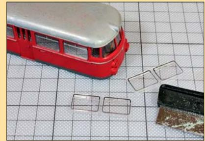
Danach wurden die Fenstereinsätze montiert. Durch die neue Fensteranordnung müssen die Teile zugeschnitten werden.
