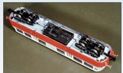
Uli Leibfarth baute vor einigen Jahren die Version der Härtsfeldbahn aus einem Gehäuse von Günther-Modellbau. Ein solcher Umbau ist auch auf Basis des Brekina-Modells möglich. Zusätzlich zum Umbau in die Version der Südharzeisenbahn wurden hier Griffstangen an den Türen und am Rangiertritt, die hoch liegenden Regelspurpuffer mit den darunter befindlichen Scheinwerfern und eine Kupplung für aufgebockte Regelspurwagen montiert.
