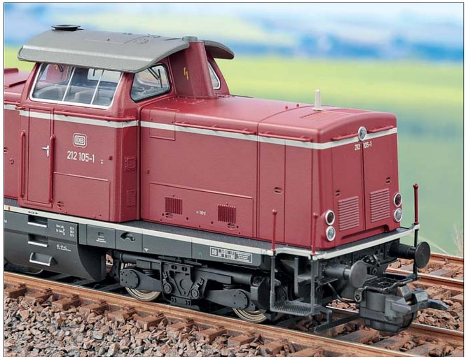
rung freistehend durchgebildet, auch die Bremsklötze in Radebene fehlen nicht. Lediglich die große runde Öffnung in Drehgestellmitte unter der Wiegenabstützung hätte etwas mehr Tiefe vertragen. Die Schraubenfedern der Wiegenabstützung wurden ebenso wenig vergessen, wie der Sifa-Schaltkasten mit Antriebswelle als separates Teil auf der linken Seite des vorderen Drehgestells.
