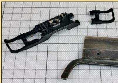
Der Rahmen einer 101 von Roco in N wurde zwischen Motor und Drehgestell zersägt und an den Kanten beschliffen.
