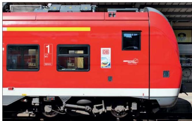
Die Wagenkästen stützen sich auf Mitteldrehgestelle in Jacobsbauart (links). Sie sind nahezu baugleich mit den angetriebenen Enddrehgestellen (rechts). Zwischen Drehgestell und Wagenkasten sind Wankstützen und Längsdämpfer für einen ruhigen Lauf angebracht.
