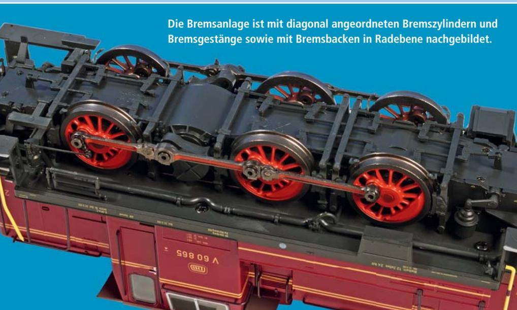
Die Bremsanlage ist mit diagonal angeordneten Bremszylindern und Bremsgestänge sowie mit Bremsbacken in Radebene nachgebildet.
