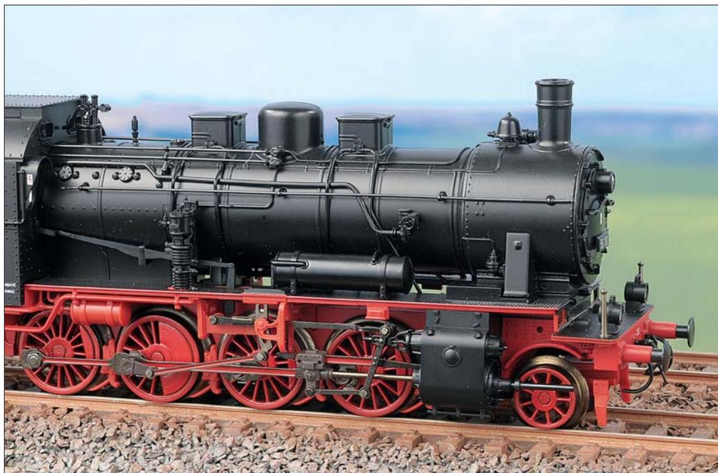
Der Kessel ist auf beiden Seiten preußisch-üppig mit Leitungen und Stellstangen bestückt, die zumeist frei stehend angesetzt sind. Die Kesselspeiseventile liegen auf halber Kesselhöhe; die Handräder zeigen durchbrochene Speichen. Links: Das werkseitig mitgelieferte Personal ist offensichtlich zu beschäftigt, um aus dem Fenster zu sehen ...
