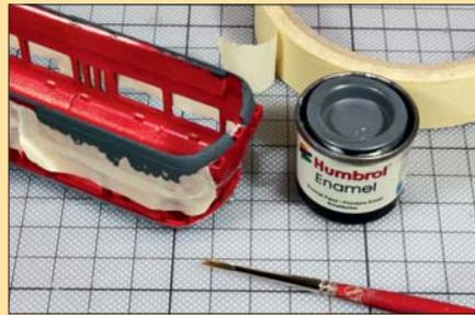
Durch Abkleben konnte eine gerade Farb-trennkante zum Dach und dem unteren Bereich geschaffen werden.
