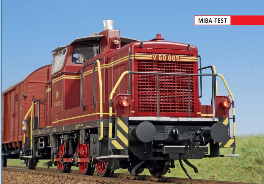
**Oben:** Für den Schiebetrieb kann das rote Schlusslicht über die in den DB-Laternen integrierten roten LEDs eingeschaltet werden.
