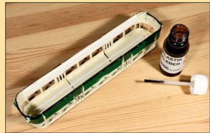
Eingeklebte Profile aus Kunststoff im Inneren des Wagenkastens verleihen Stabilität.
