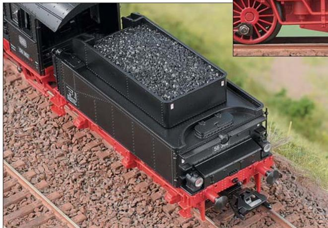
Das Tendergehäuse zeichnet sich aus durch eine feine Nietdarstellung. Einzel ange-setzt sind die Griffstangen sowie die Dampfheizung linksseitig am Rahmen. Die drei Laternen leuchten gleichmäßig hell.
