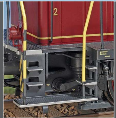
Trittstufen mit Rautenblech, Bremszylinder mit Flansch für die Bremswelle und Magnet für die Indusi unter dem kurzen Vorbau.
