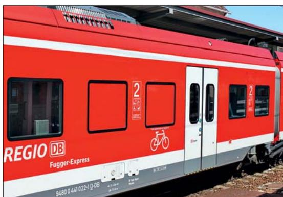
Hinter den beiden geschlossenen Seitenscheiben befindet sich das Toilettenmodul. Für einen späteren Umbau können hier wieder Fenster eingesetzt werden (oben). Die Schwenk-Schiebetüren sind bei der DB-Variante bodentief angeordnet und 1300 mm breit.
