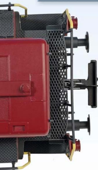
Links: Das Gitter der Rangiererbühne ist durchbrochen. Gut zu erkennen auch der Umstellhebel an der DB-Einheitslampe.
