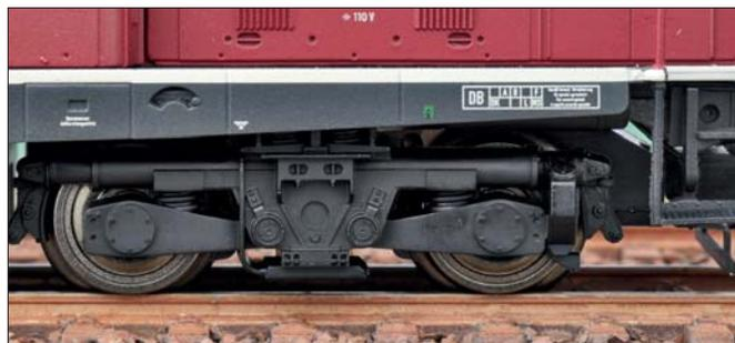
Die Gravur der Drehgestellblenden ist detailgenau und zeigt deutlich die damals innovative Rohrkonstruktion und die drehbar gelagerten Achslenker.
