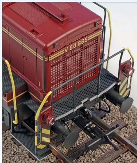
triebene Radsatz liegt fest im Rahmen, während der hintere Radsatz pendelnd gelagert ist. Der mittlere hat Höhenspiel und wird per Federkraft aufs Gleis gedrückt.
