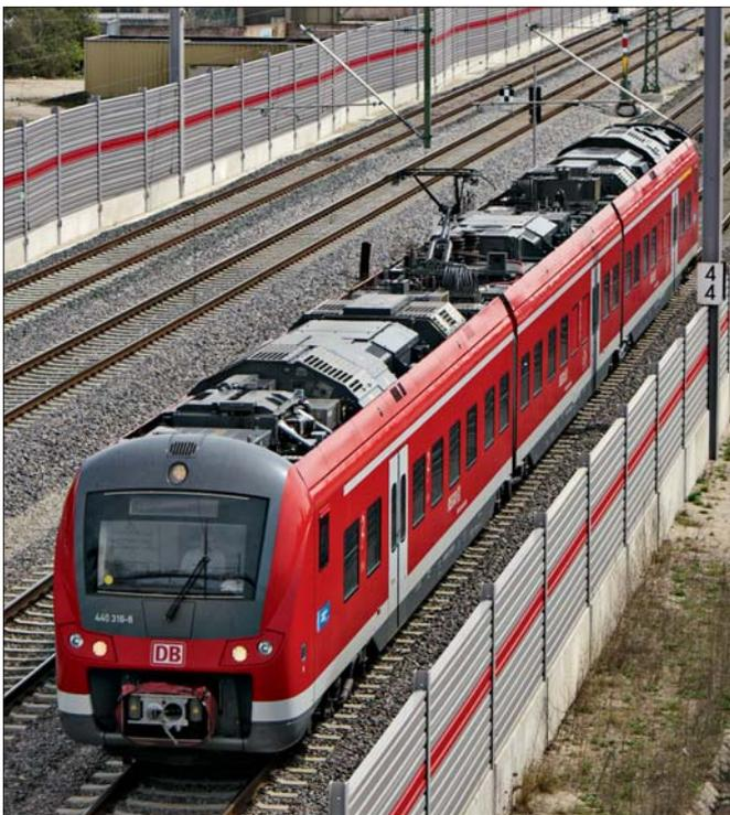
Auf dem Dach sind die oben angeordneten Aggregate zu erkennen. Auf dem Endwagen vorne beginnend: Führerstandsklimagerät, Transformator und Antriebsumrichter, Fahrgastraum-Klimagerät, Hilfsbetriebeumrichter sowie der Fahrmotorkühler. Der Wagen dahinter trägt den Stromabnehmer mit Hochspannungsausrüstung und zwei Hauptschaltern, Batterien und das Klimagerät für den Fahrgastraum.
