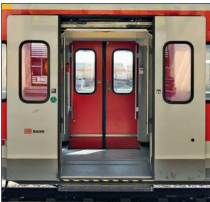
Hinter den geöffneten Schwenk-Schiebetüren befindet sich der Niederflrbereich mit abgeschrägter Rampe zum 550-mm-Einstieg.
