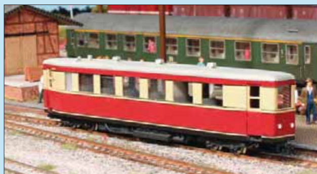
Das Fahrzeugdach ist abnehmbar und besteht, wie die Sitzbänke, aus Kunststoff.
