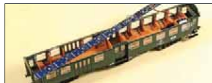
S-05: Wekom Lichtplatine mit Prozes- sor-Steue- rung
