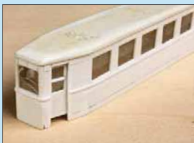
Bearbeitete Polystyrol-Platten bilden den Wagenkasten des Triebwagen-Modells.
