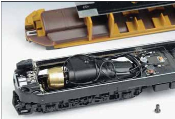
Wie beim Vorbild liegt der Motor schräg im angetriebenen Drehgestell. Er wirkt jedoch nur auf eine Achse. Fotos: MK
