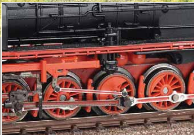
Umlauf mit angespritzter Wasserpumpe. Speichenräder und Steuerung hinterlassen einen zierlichen Eindruck.
