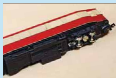
Auch der Hauptrahmen mit den beiden Drehgestellen entstand im Eigenbau.
