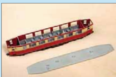
Das Fahrzeugdach ist abnehmbar und besteht, wie die Sitzbänke, aus Kunststoff.
