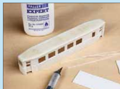
Aus dünnen Profilen von Evergreen entstanden Zierleisten und Fensterrahmen.
