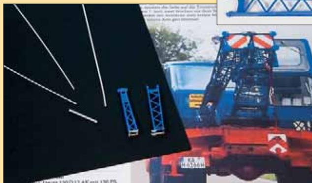
Links: Aus Evergreenprofilen und einem Fallrohr entstehen die neu zu gestaltenden Enden der beiden Teile des geteilten Auslegers.
