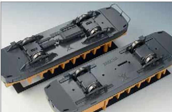
Auch die Fahrwerke stammen sinnvollerweise aus einer Form. So können Antriebsattrappe und Achslager in jeweils korrekter Form angesetzt werden. Ebenfalls angesetzt: Die Rahmenverstärkungen an den Anhebepunkten.
