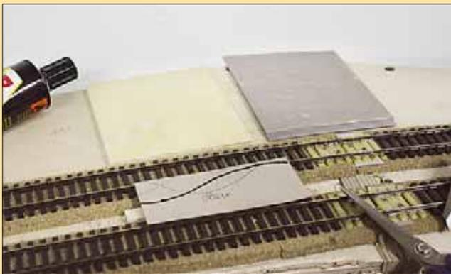
Zum Bau des Bahnübergang kam eine PVC-Hartschaumplatte zum Einsatz (Marke „Creativ“ von Robex, Bezug: Toom-Baumarkt). Diese lässt sich sehr einfach schneiden und feilen (und auch gravieren). Im Kleisenbereich muss die Platte noch etwas dünner geschnitten werden.
