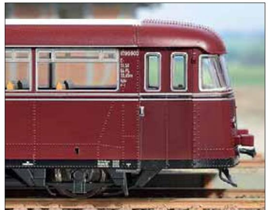
**Unten:** Zwischen Motor- und Bei-wagen kann die Verbindung über eine einfache Deichsel in der Rockinger-Kupplung hergestellt werden oder über eine Imitation von Scharfenbergkupplungen.
