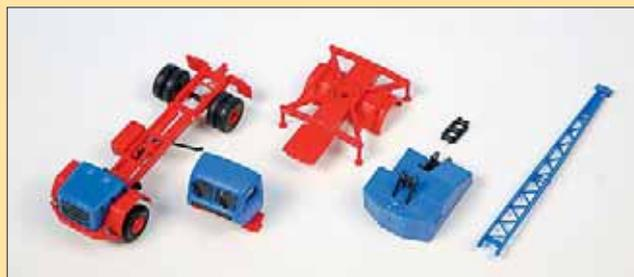
Die wesentlichen, bereits montierten Bauteile: Fahrwerk, Führerhaus, Baggerbasis mit Abstützungen noch ungeteilter Ausleger.
