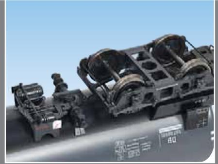
Nachbildung von Bremszylinder, Hauptluftbehälter, Mitten- und Achsbremsgestänge. Das Innenmaß einzelner Radsätze ist mit 28,5 mm etwas knapp bemessen.
