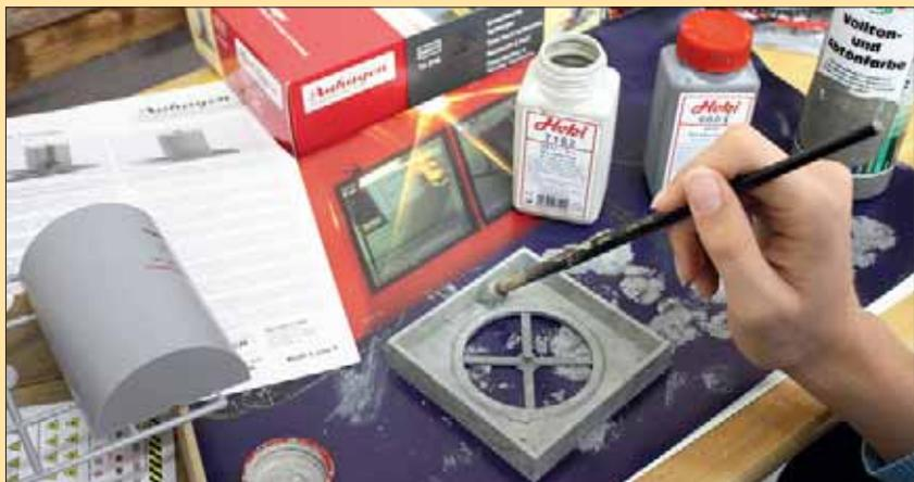
Die Schutzmauern um die Tanks erhielten einen betonfarbenen Anstrich. Nass-in-nass aufgetupft ergeben die drei unterschiedlichen Grautöne zugleich eine realistischere Betonstruktur. Beim Zusammenbau helfen einige Gummiringe, die beide Hälften bis zum Abbinden des Klebers zusammenhalten. Die Verbindungs-nähte mussten danach noch versäubert werden.
