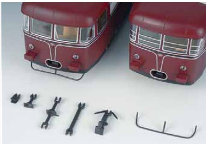
Die fünf unterschiedlichen Kupplungen, welche jedem Fahrzeug doppelt beiliegen, ermöglichen je nach dargestellten Zeitraum und Betriebszustand immer eine vorbildgerechte Bestückung der Front. Der Schienenrümer liegt vorsorglich jedem Modell als einzelnes Ersatzteil bei.
