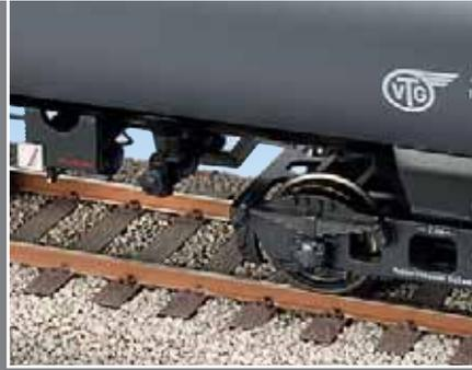
Details der Bremse mit dem Umsteller für die H1k-G-Bremse, des Entnahmestutzens mit angeedeutetem Absperrhahn und Anschriften am Drehgestell
