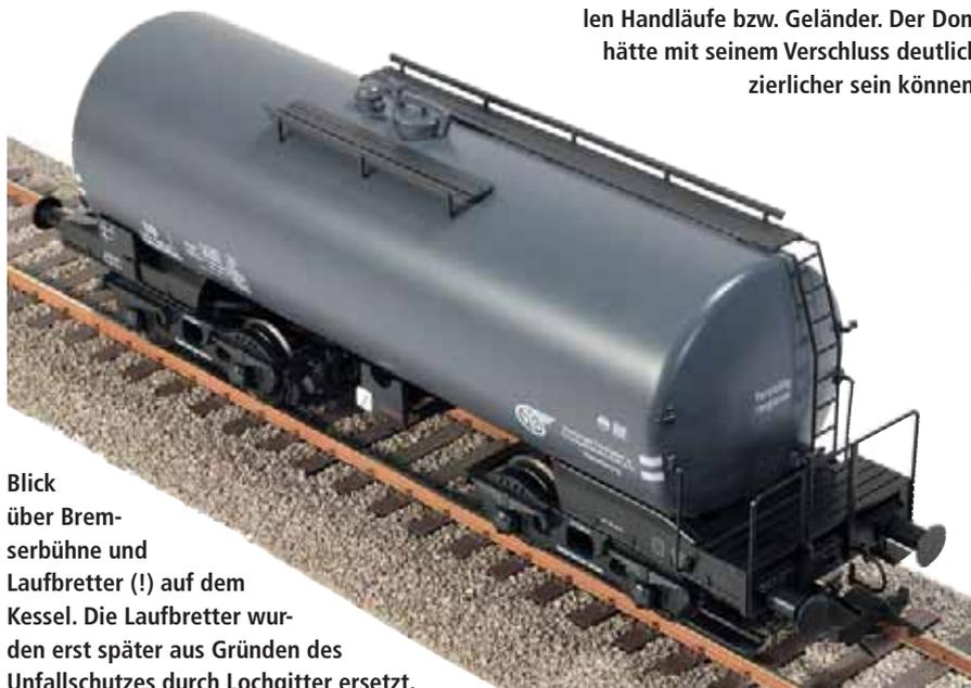
Am oberen Ende der Aufstiegsleiter fehlen Handläufe bzw. Geländer. Der Dom hätte mit seinem Verschluss deutlich zierlicher sein können.
