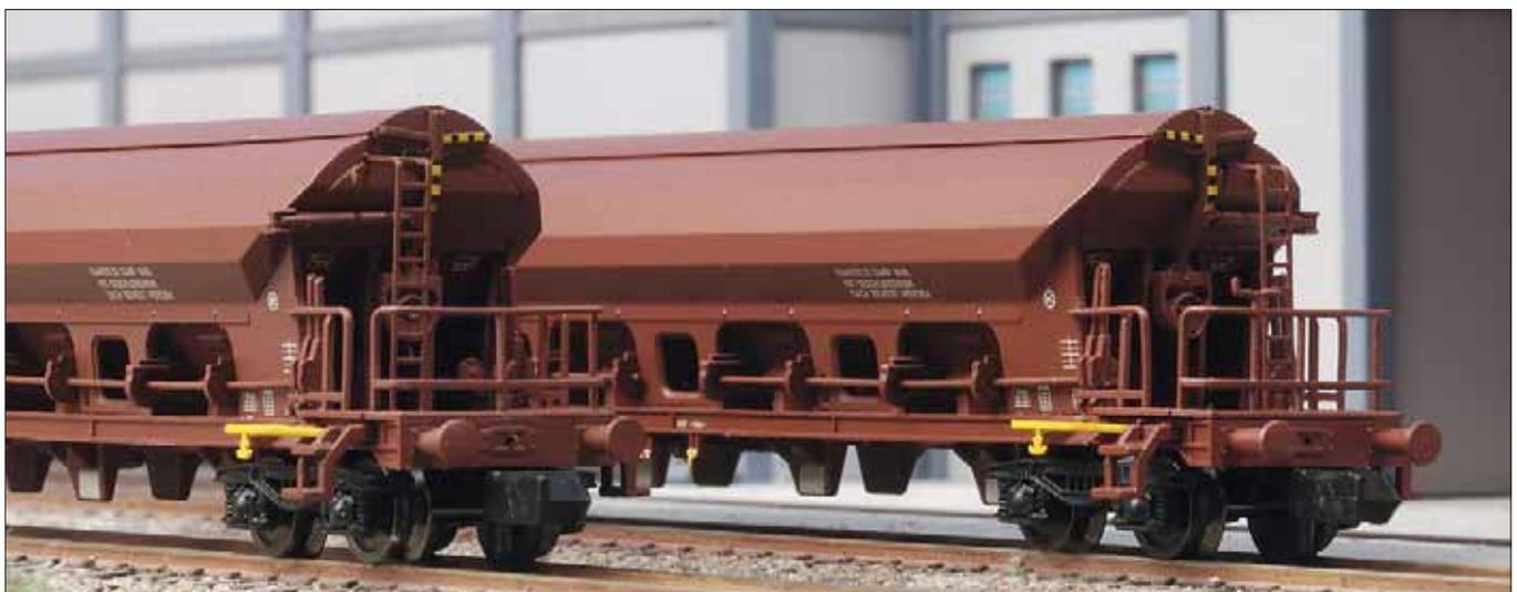
Die Bühnen der Wagen unterscheiden sich lediglich durch die Darstellung der Handbremskurbel. Aufstiegsleitern und Zurrösen mit Schutzbügel sind Ätzteile. Auch der Öffnungsmechanismus der Schieber ist an den angesetzten Teilen nachgebildet.
