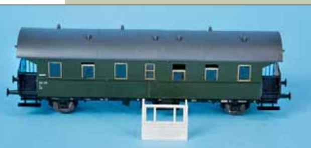
und Dach aus Polystyrolplatten geschnitten und verklebt. Die Fensterrahmen entstanden aus Evergreenstreifen. Ein Teil der vorhandenen Wagenfenster wird von der Inneneinrichtung des Stellwerks verdeckt; sie wurden deshalb außen mit „Blechen“ aus passend zugeschnittenen 0,5 mm starken Kunststoffstreifen verkleidet.
